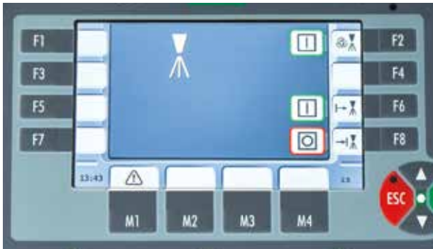
Funktionen Baustellenanfang/-ende Damit genau an der gewünschten Stelle und über die gesamte Arbeitsbreite der Sprühvorgang beginnt bzw. endet, gibt es die Komfortfunktionen für Baustellenanfang (F6) und Baustellenende (F8).
