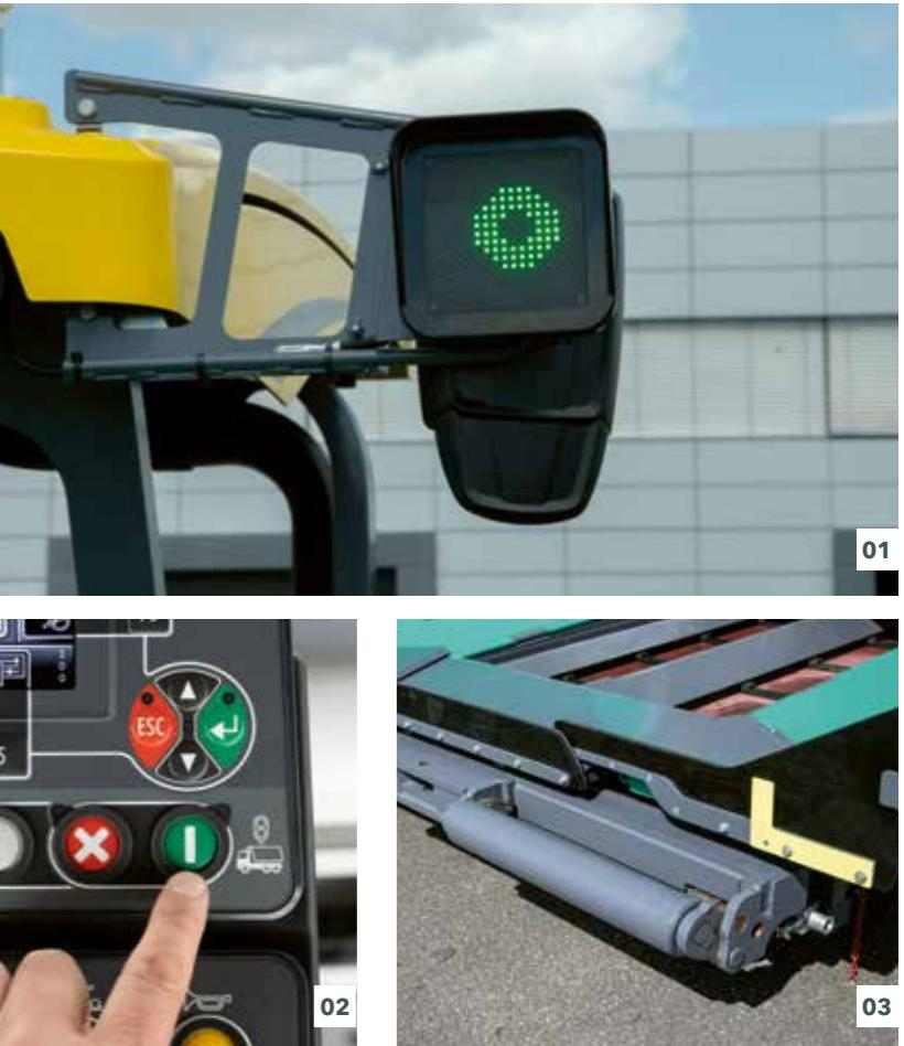
und damit auf den Asphalt übertragen werden. Zusätzlich ist der Abdruckbalken pendelnd aufgehängt, das ermöglicht das Schieben von LKWs auch in Kurven.
