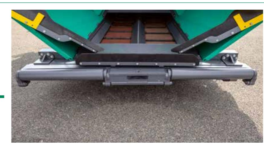
Besonders breite und pendelnd aufgehängte LKW-Abdruckrollen ermöglichen auch in Kurven komfortables und ruckfreies Beschicken durch Mischgutfahrzeuge. Die Abdruckrollen lassen sich komplett in Längsrichtung verstellen und so an die Geometrie des Mischgut-LKWs anpassen.
