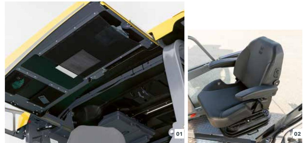
**01** Gepäcknetze im Dach sowie Flaschenhalter an den Sitzen sorgen für mehr Ordnung auf der Bedienplattform. Die Dämmung im Dach reduziert Staubhitze und Geräuschentwicklung.
