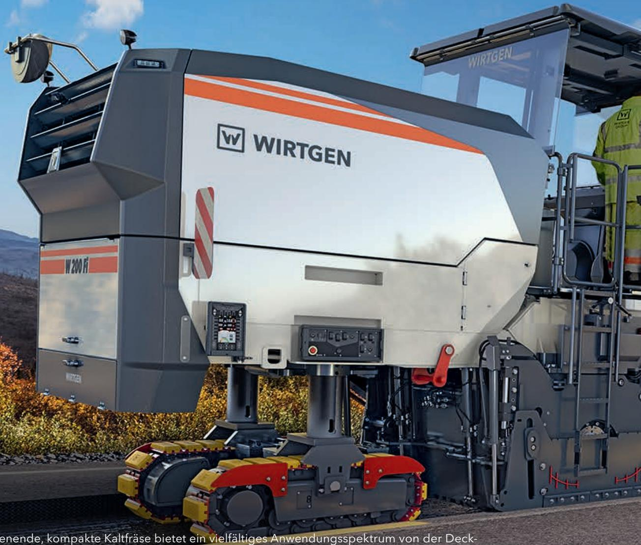
Die einfach zu bedienende, kompakte Kaltfräse bietet ein vielfältiges Anwendungsspektrum von der Deckschichtsanierung über den Komplettausbau bis hin zu Feinfräsarbeiten.
