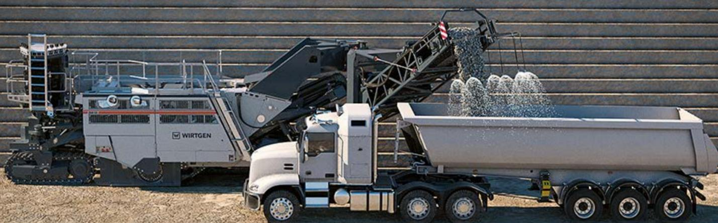
**01** Eine Wasserberieselung am Abwurfband reduziert die Staubentwicklung beim Verladen trockener Gesteine.
