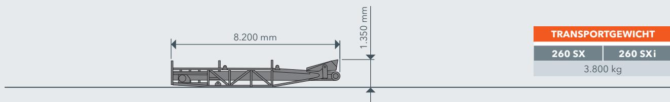
4. Kollo: Modul 4 (Schneidwalzenaggregat), Breite 3.850 mm
