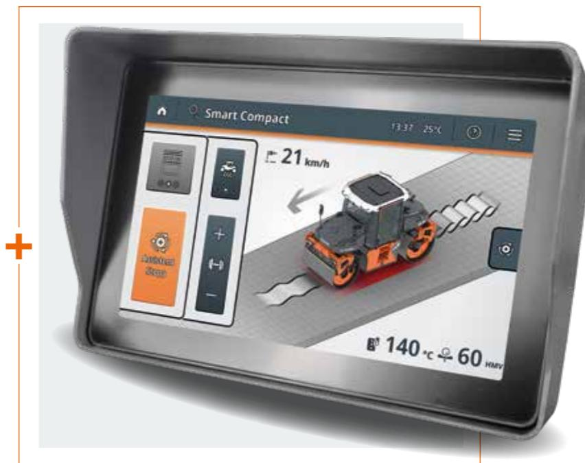
Die Ein- und Ausgabe der Daten erfolgt über das zusätzliche Smart Display am Armaturenbrett. Dort sieht der Fahrer die aktuell bearbeitete Schicht, die Fahrtrichtung, die Windgeschwindigkeit, die Asphalttemperatur, den Verdichtungswert (HAMV) und die aktuellen Verdichtungseinstellungen für jede Bandage.
