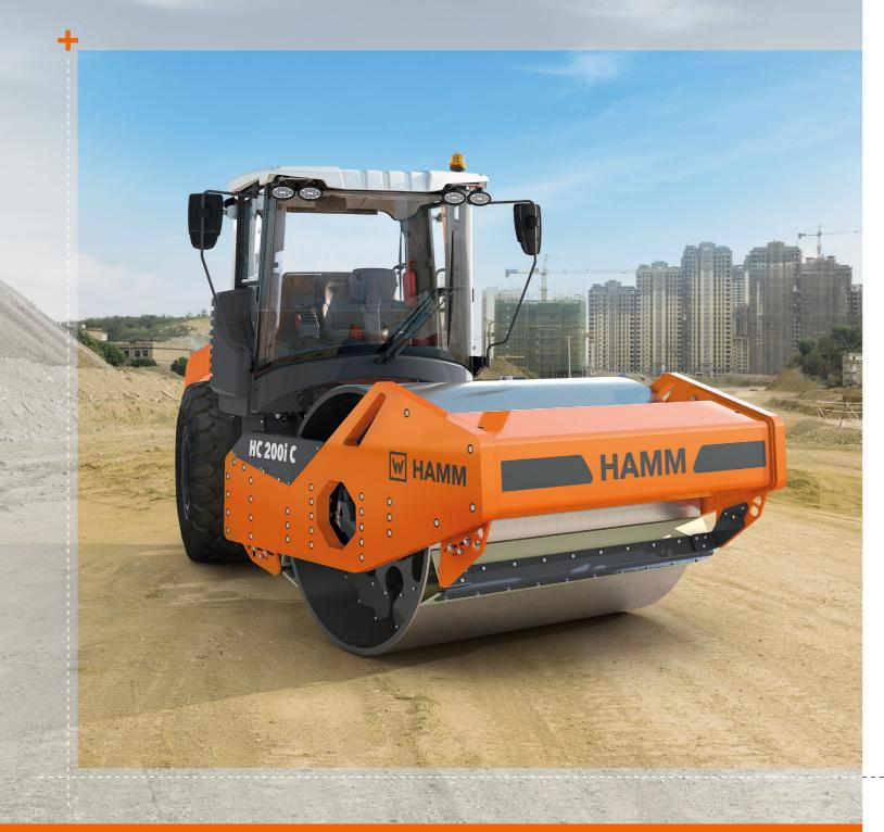
Die Walzenzüge der Serie HC sind leistungsstarke Profis mit großer Verdichtungskraft. Durch das 3-Punkt-Pendelknickgelenk und große Böschungswinkel vorn und hinten sind sie extrem manövrierfähig bei optimaler Fahrstabilität. Die Serie HC ist mit Schnittstellen und Hardware vorbereitet auf die Qualitäts- und Kommunikationsanforderungen zukünftiger Baustellen. Zudem unterstützt der Verdichtungsassistent Smart Compact aktiv bei der Wahl der Verdichtungsparameter.
