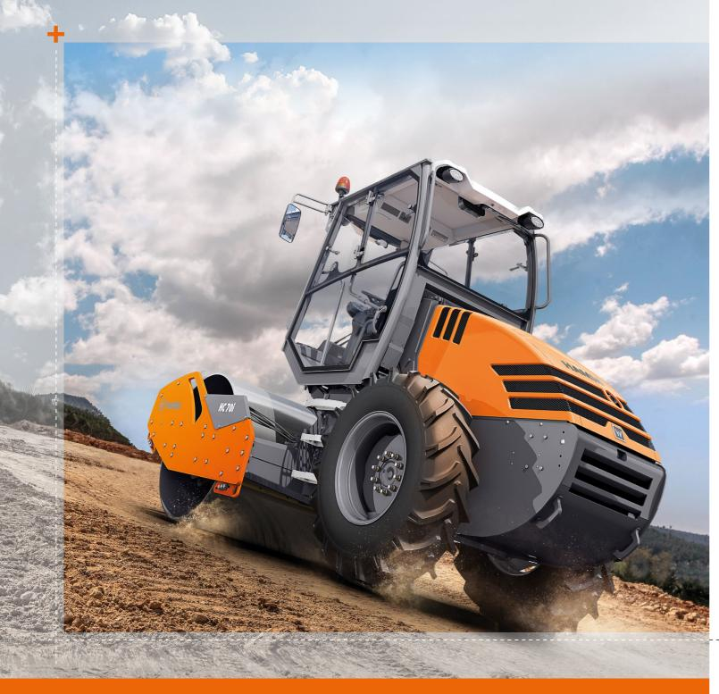
Die extrem kompakten, sehr kurzen Walzenzüge der HC CompactLine bieten eine enorme Steigfähigkeit bis zu 60 % und maximale Bodenfreiheit. Der Antrieb erfolgt über moderne Radmotoren. Der sehr kurze Radstand und das 3-Punkt-Pendelknickgelenk sorgen für optimale Fahr- und Handlingseigenschaften – ideal für enge Baustellen und die Verdichtung auf unwegsamem Gelände.
