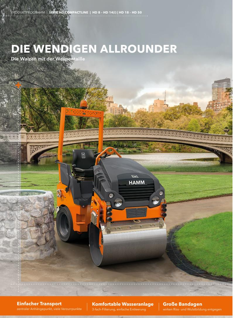
Die knickgelenkten Kompaktwalzen der HD CompactLine sind Alleskönner für den Asphaltbau, den Erdbau und den GaLaBau. Ihre Bedienung ist extrem einfach und erfordert keinerlei Sprachkenntnisse. Das Design mit der Wespentaille ergibt optimale Sichtverhältnisse, und das 3-Punkt-Pendelknickgelenk sorgt für herausragende Fahr- und Handlingseigenschaften.
