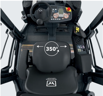
Con carácter opcional, el asiento del conductor se puede desplazar y girar un total de 350° eléctricamente.
