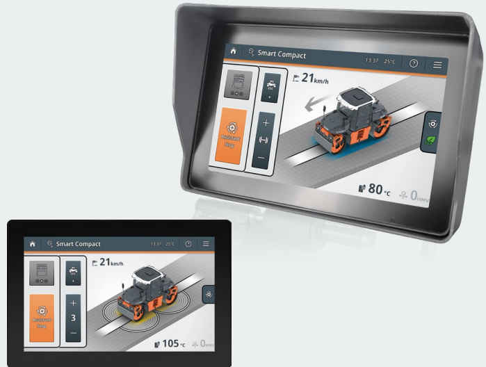
Ein Monitor am Armaturenbrett zeigt aktuelle Einstellungen und Informationen zur Verdichtung an.
