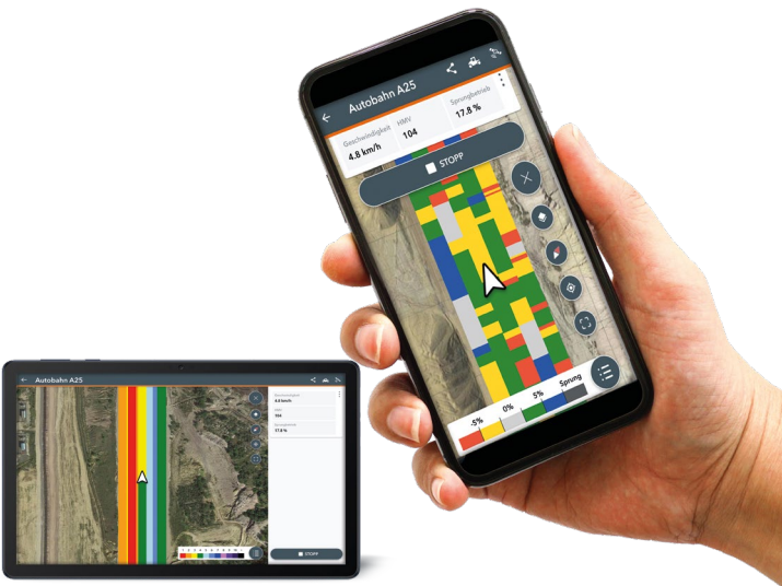
Der Datenaustausch zwischen Maschinensteuerung, der App Smart Doc und dem Smart Receiver erfolgt per Bluetooth.
