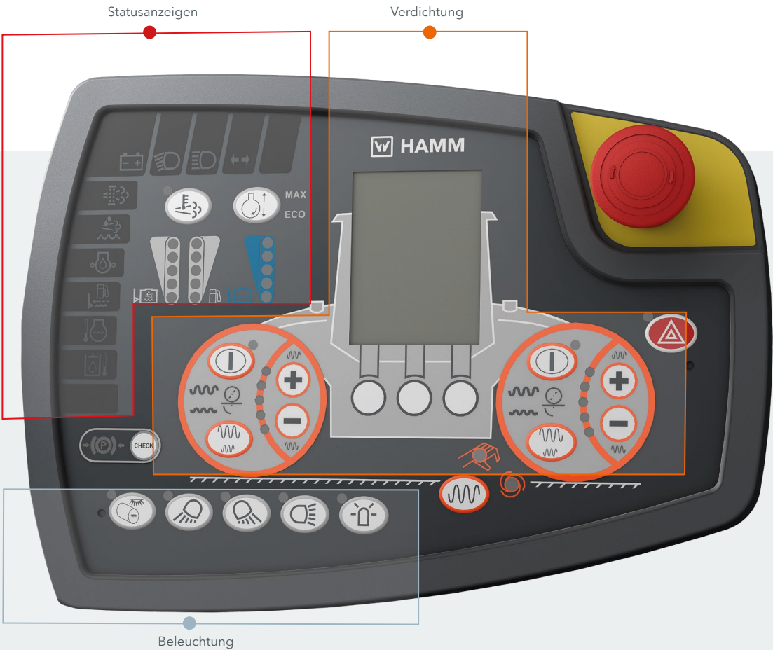
Auf dem Armaturenbrett neben dem Lenkrad befinden sich Status- und Parameteranzeigen sowie Taster, die nur selten betätigt werden.
