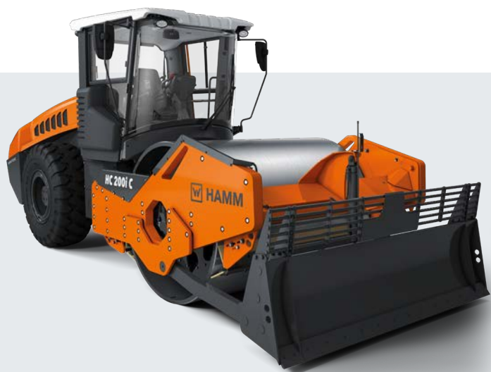
La lame de nivellement est disponible pour les machines jusqu'à 20 t avec rouleau lisse ou rouleau à pieds dameurs.
