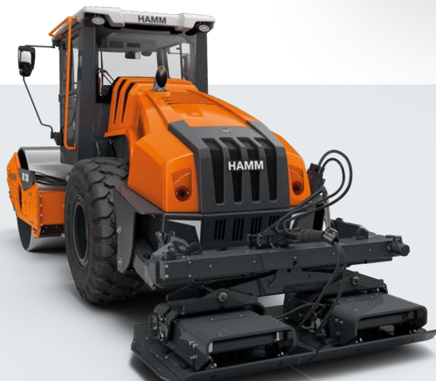
Le compacteur à plaque vibrante peut être décalé latéralement. Cela permet un compactage même dans les bordures critiques.
