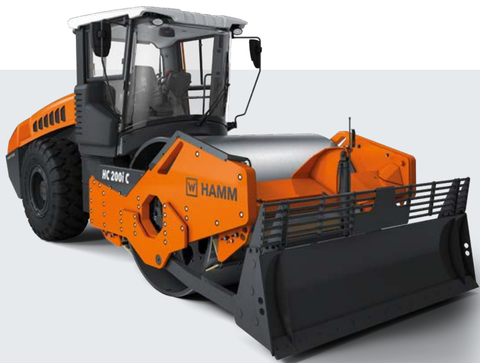
La hoja de empuje aporta a la máquina hasta 20 t con tambor liso o de pata de cabra.
