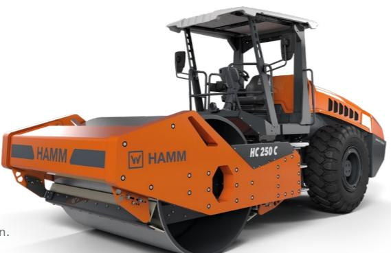
Die Walzenzüge der Serie HC mit offener Fahrerplattform können mit ROPS-Bügel und Schutzdach ausgestattet werden.
