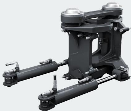
Das 3-Punkt-Pendelknickgelenk sorgt für exzellente Fahrstabilität und dämpft Stöße wirkungsvoll.
