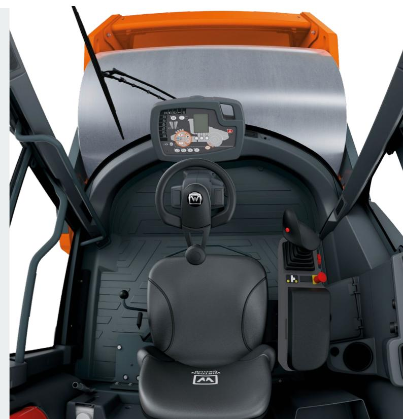
Im geräumigen Easy Drive-Fahrerstand sind die wichtigen Taster jederzeit einsehbar. Für sämtliche anderen Bedienelemente gilt: Je häufiger sie betätigt werden, desto näher am Joystick befinden sie sich.
