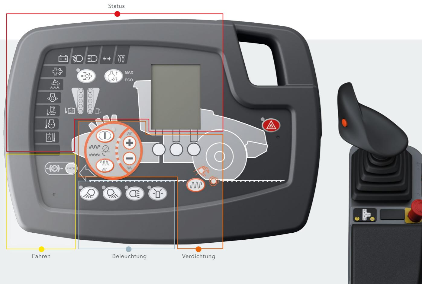
Auf dem Armaturenbrett vor dem Lenkrad befinden sich Status- und Parameteranzeigen sowie Taster, die nur selten betätigt werden. Alle Anzeigen und Schalter sind in funktionalen Einheiten zusammengefasst und farblich abgegrenzt. Das erleichtert die Bedienung, denn hier gilt wie bei allen anderen HAMM-Walzen: gleiche Farbe - gleiche Funktionsgruppe.
