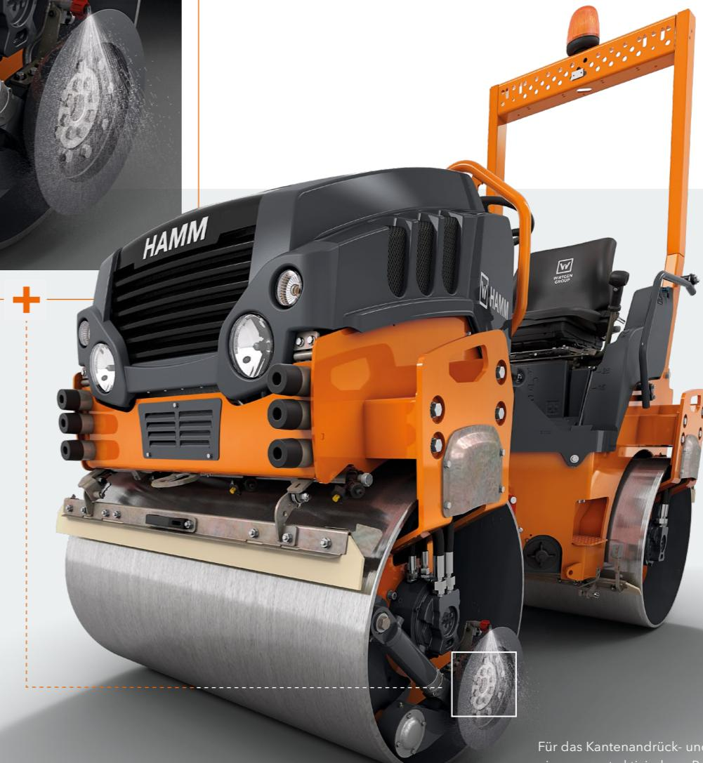
Für das Kantenandrück- und Schneidegerät gibt es eine separat aktivierbare Berieselung. Sie kann vom Fahrerstand aus über einen Schalter aktiviert werden.
