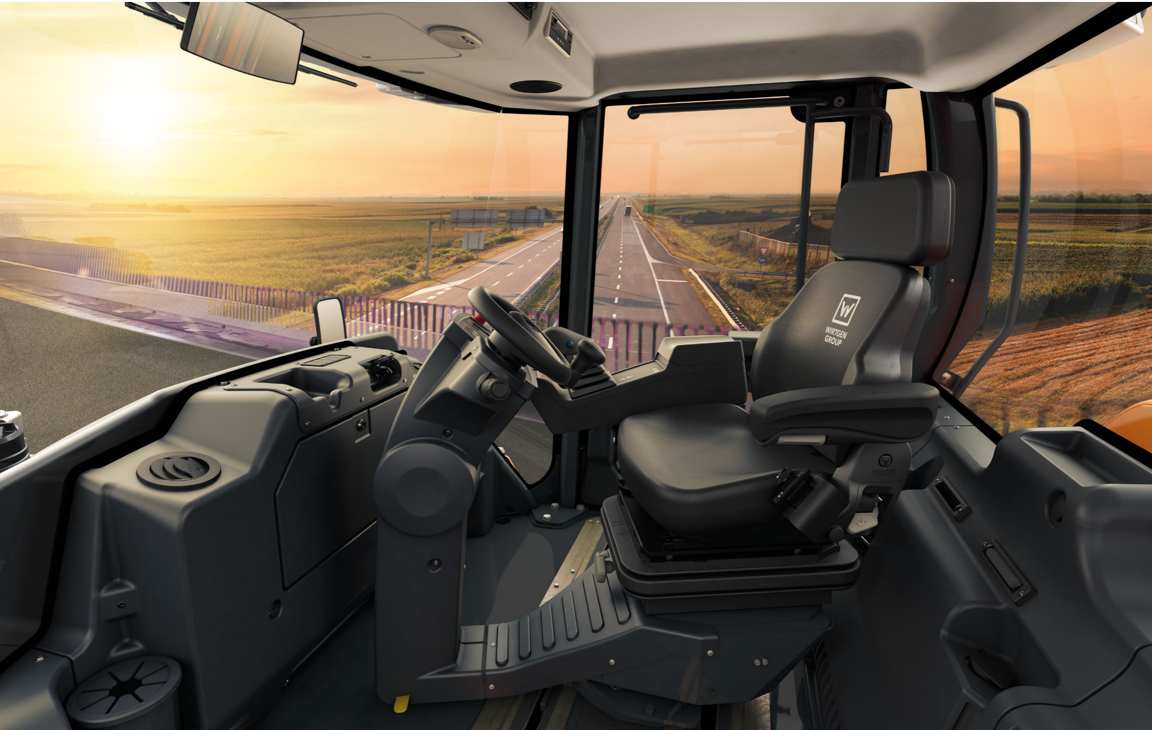
L'angle d'inclinaison du tableau de bord et du volant est réglable en fonction des besoins de l'opérateur.
