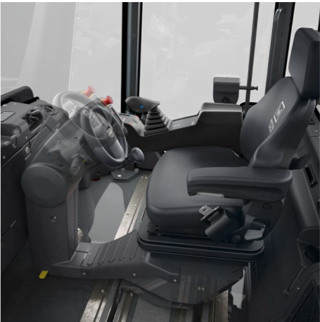
L'angle d'inclinaison du tableau de bord et du volant est réglable en fonction des besoins de l'opérateur.
