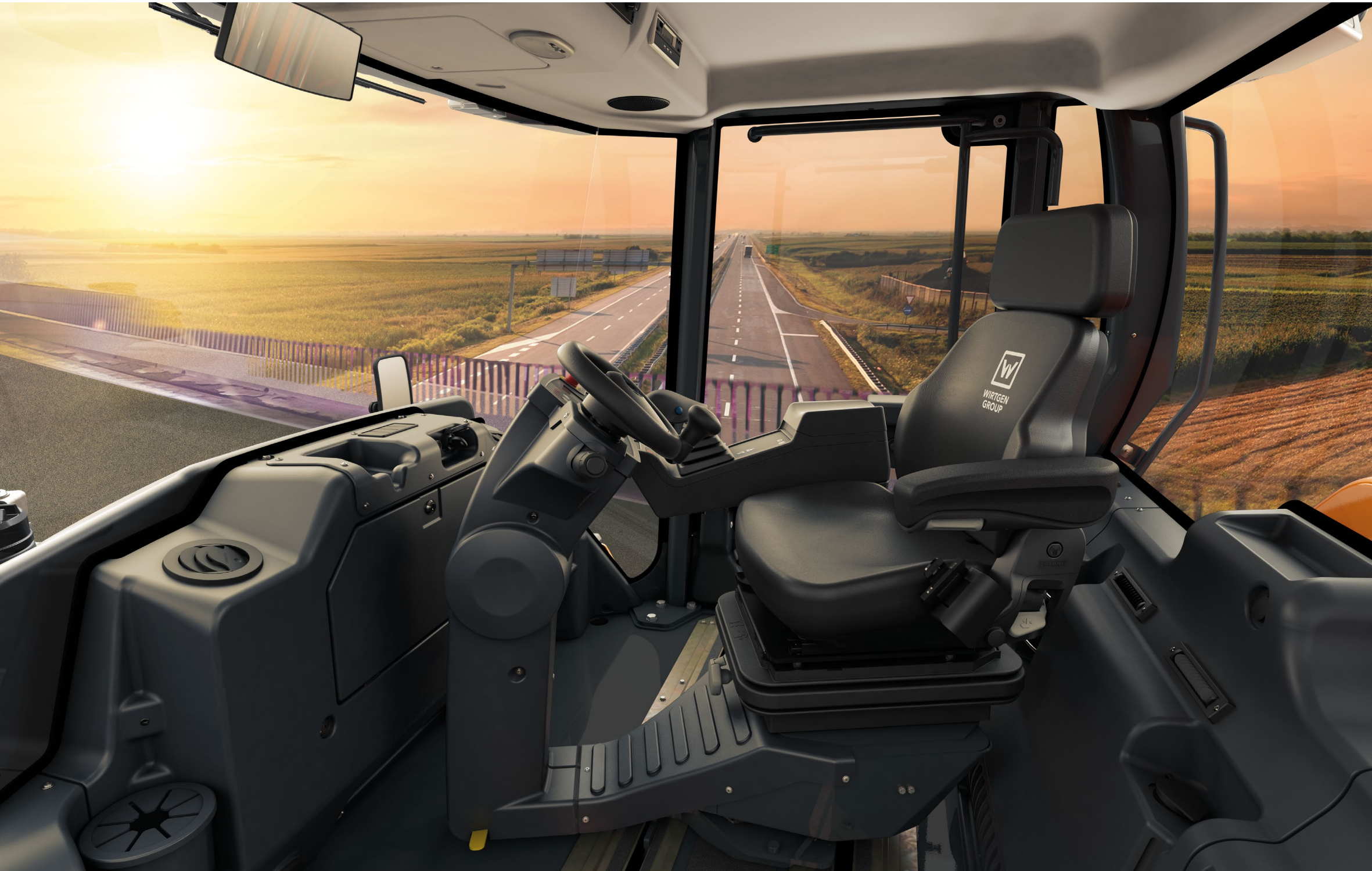
Se puede ajustar individualmente el ángulo de inclinación del tablero de instrumentos y del volante.
