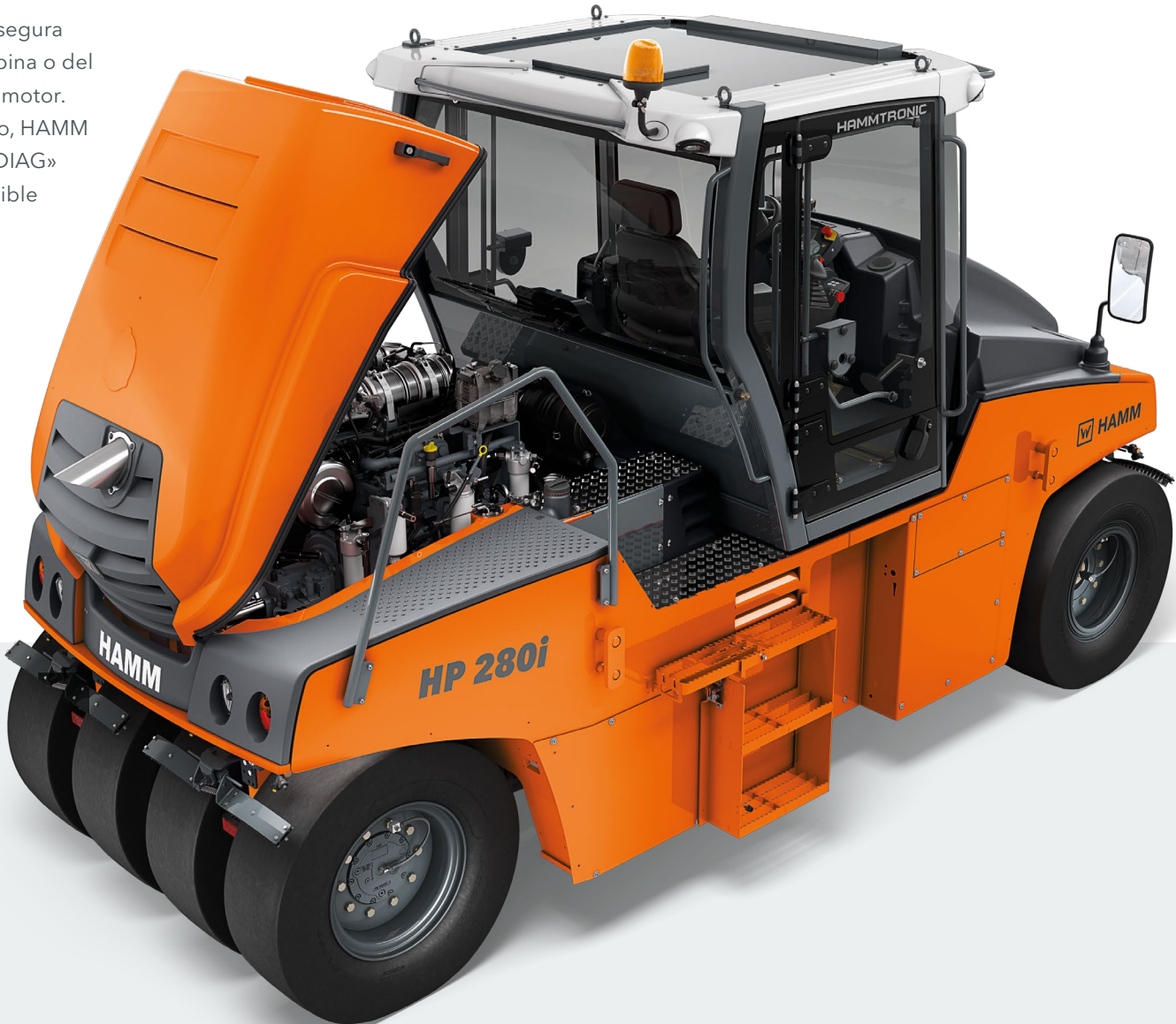
Un asidero en el lado de mantenimiento del motor garantiza la seguridad durante las inspecciones periódicas.
