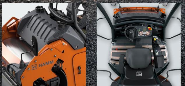
El bastidor de diseño abierto y la forma de los depósitos permiten una vista despejada de la zona situada inmediatamente delante de los tambores.
