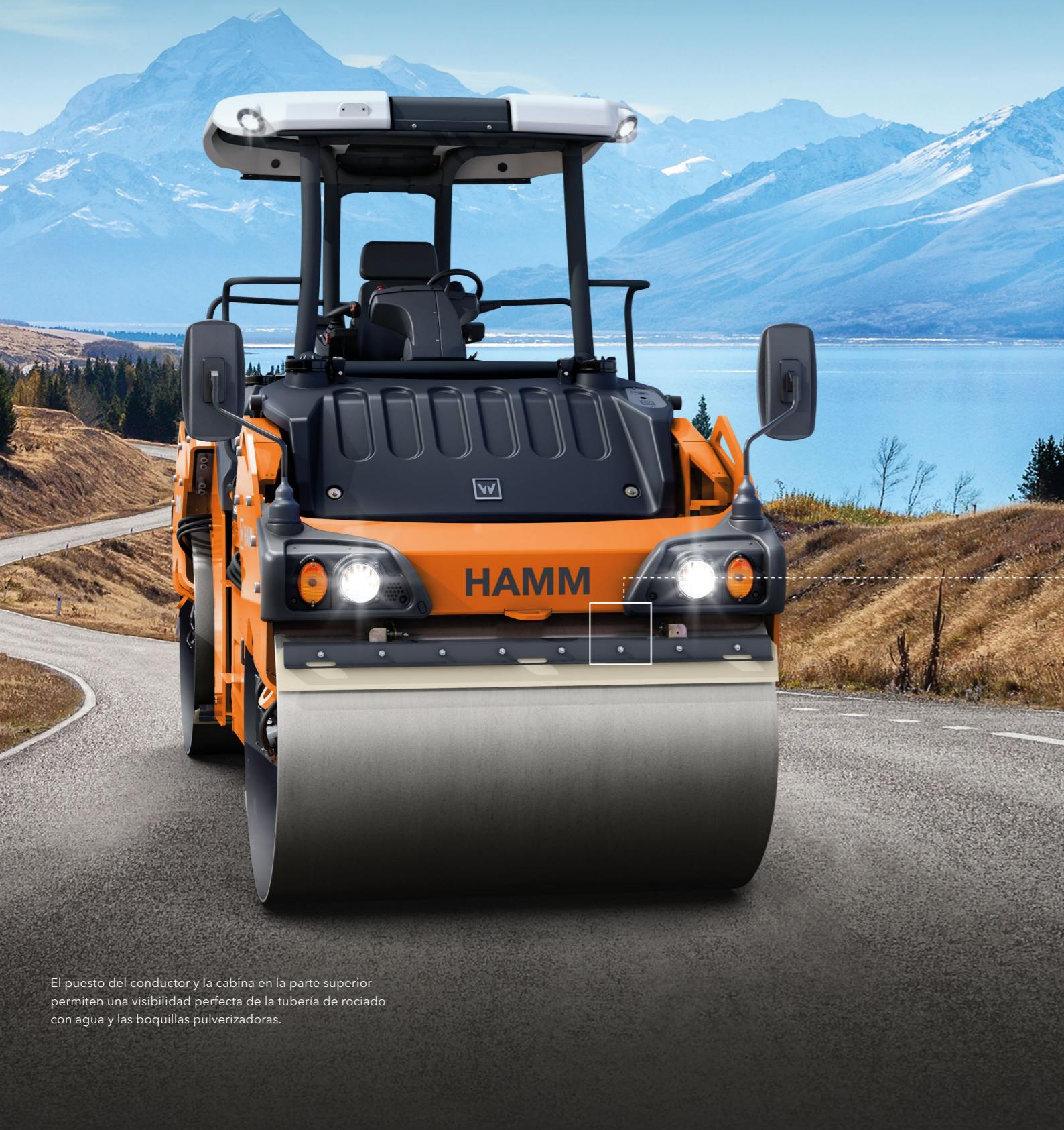
El puesto del conductor y la cabina en la parte superior permiten una visibilidad perfecta de la tubería de rociado con agua y las boquillas pulverizadoras.
