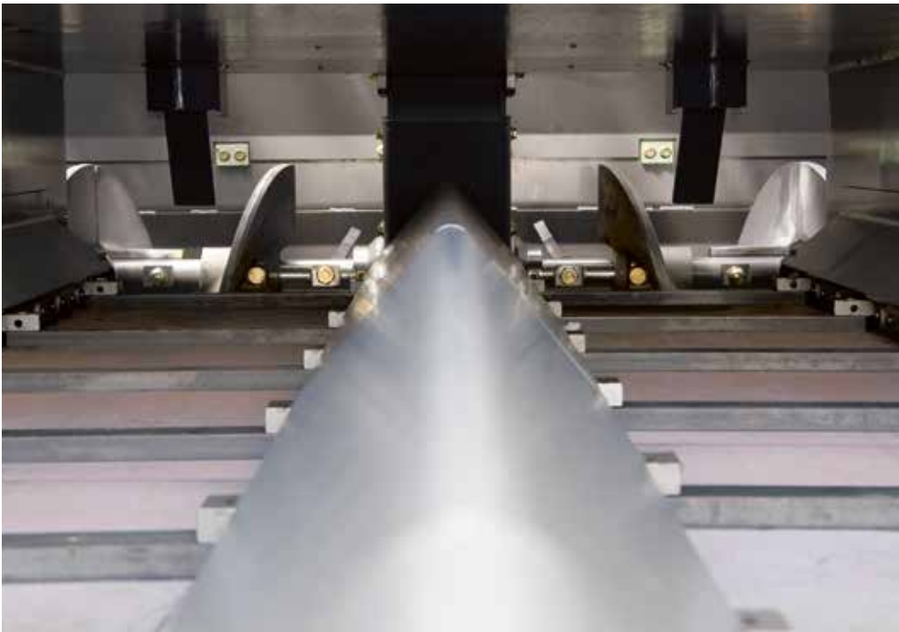
Das Kratzerband kann mit nur einem Tastendruck reversiert werden. Der Rücktransport des Mischgutes stoppt automatisch. Ebenso schnell kann das Kratzerband in die Leerlauffunktion gebracht werden.
