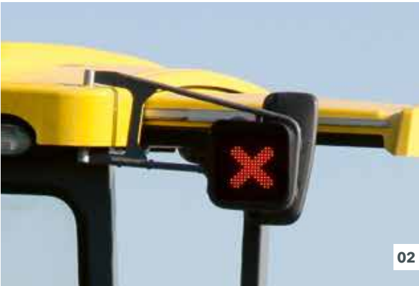
01 Taster für die Wahl der Drehzahlstufe 02 PaveDock Assistant (Option)
