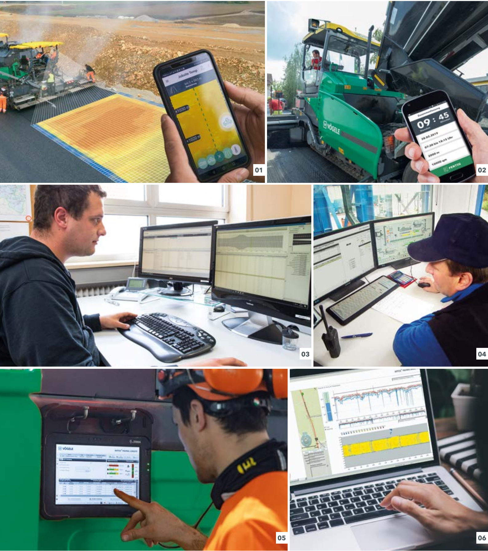
01 RoadScan: rilevamento capillare della temperatura su tutta la larghezza di stesa. 02 WITOS Paving Docu: la soluzione facile per digitalizzare la documentazione e analizzare i cantieri di stesa di conglomerato bituminoso. 03 WITOS Paving Plus: questo modulo di pianificazione e controllo permette di pianificare il progetto con estrema facilità in base alla geometria del cantiere. 04 Il modulo Materiali consente di rifornire il cantiere just-in-time. 05 Nel modulo JobSite vengono visualizzate in tempo reale tutte le informazioni necessarie alla squadra di stesa. 06 Il modulo di analisi e documentazione permette di valutare obiettivamente l'intervento di costruzione.
