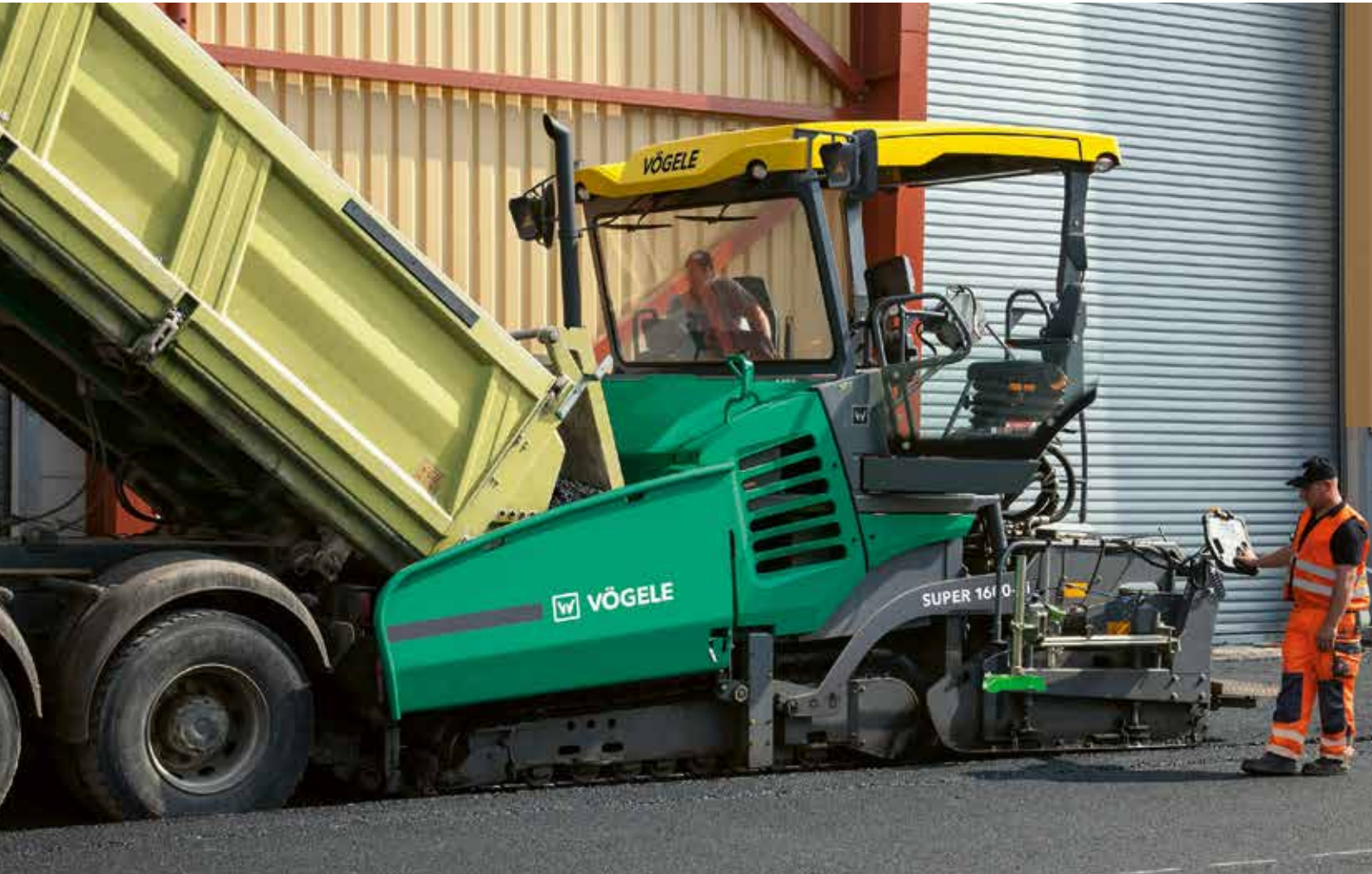
Rouleaux-pousseurs à amortisseurs PaveDock » destinés à amortir les chocs du camion d’enrobé avec une efficacité maximum.
