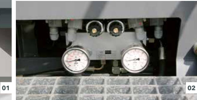
01 Die Bohlenlängsbleche werden standardmäßig mit großflächig wirkenden Heizelementen beheizt. 02 In Schwimmstellung der Bohle kann zusätzlich die Bohlenentlastung aktiviert werden.
