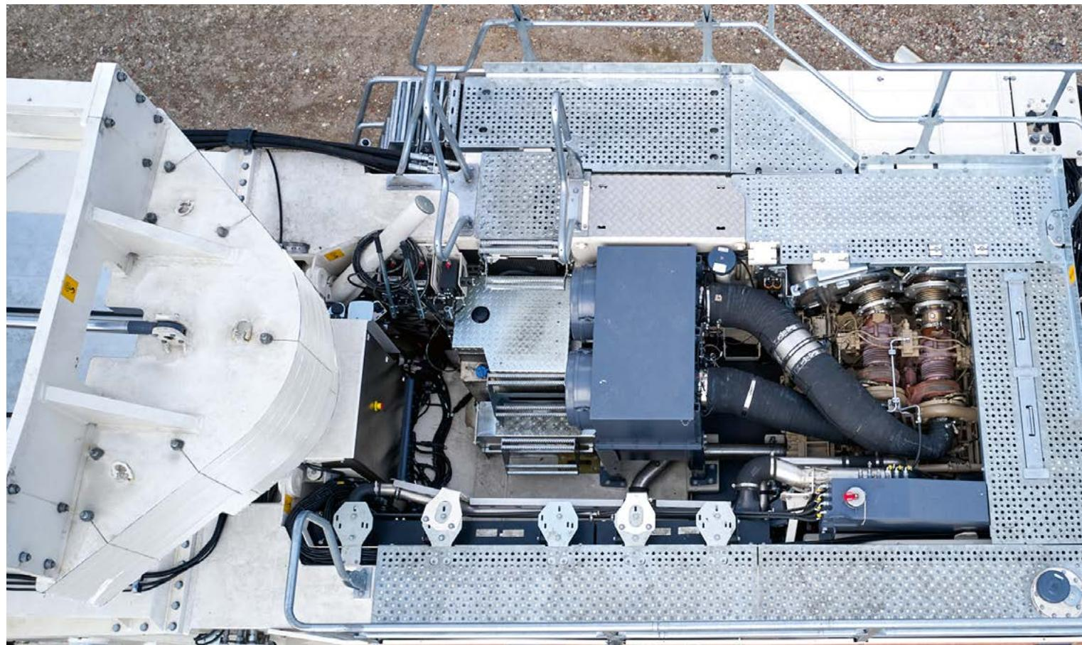
**01** Hydraulischer Meißelaustreiber und Fernbedienung der Schneidwalzendrehvorrichtung gut zugänglich und stets einsatzbereit.
