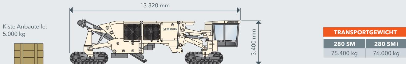
2. Kollo: Modul 2 (Drehkranz, Bandaufhängung, Kontergewicht, Transportgestell), Breite 3.000 mm
