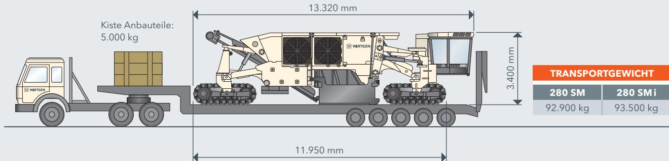
2. Kollo: Modul 2 (Drehkranz, Bandaufhängung, Kontergewicht, Transportgestell) und Modul 3 (Abwurfband), Breite 3.000 mm
