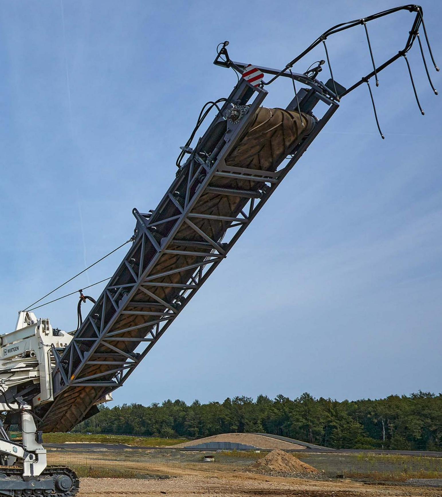
Leistungsstarker Surface Miner zur zuverlässigen, selektiven Gewinnung von Rohstoffen mittels Direktverladung, Seitenversturz oder Cut-to-Ground. Rohstoffe werden in einem Arbeitsgang, ohne Bohren und Sprengen, umweltfreundlich und in reinster Qualität gewonnen und direkt gebrochen. Das leistungsstarke, heb- und schwenkbare Heckladeband mit verschiebbarem Kontergewicht und perfektem Materialfluss ermöglicht die Beladung von SKW mit einer Nutzlast bis 100 Tonnen.
