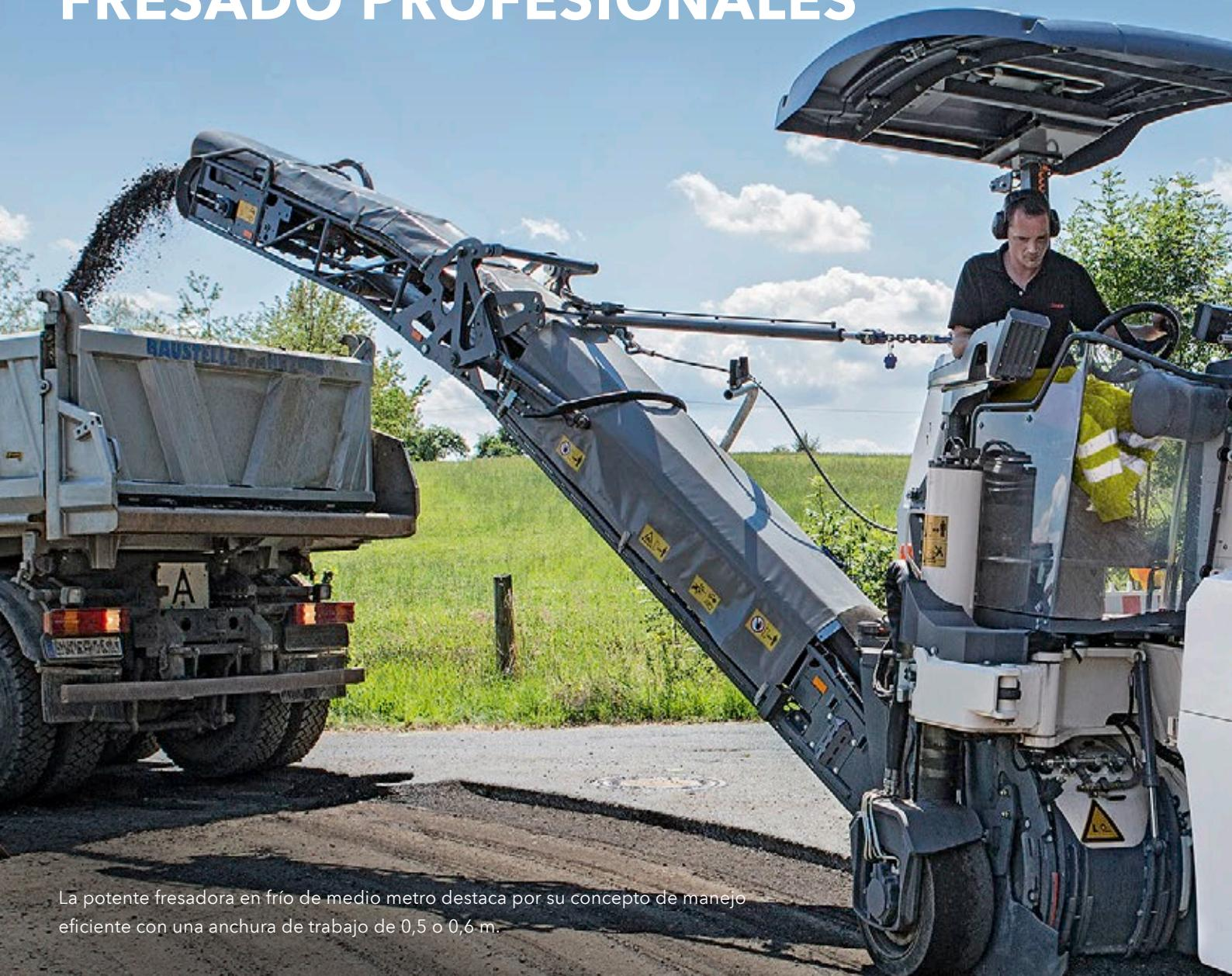
La potente fresadora en frío de medio metro destaca por su concepto de manejo eficiente con una anchura de trabajo de 0,5 o 0,6 m.
