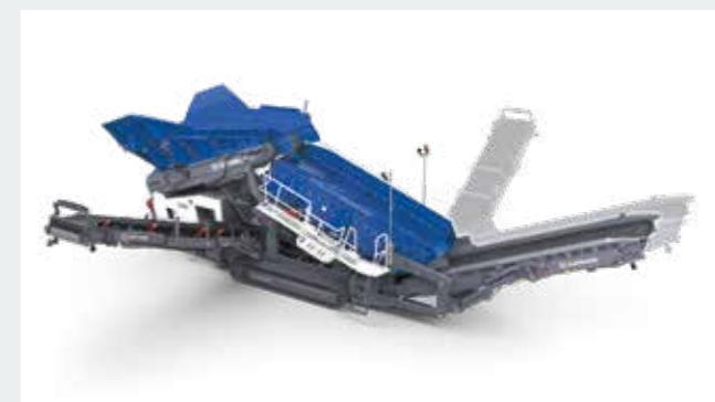
**i** L'MSS 802(i) EVO può azionare un nastro da cumulo mediante una porta idraulica (equipaggiamento opzionale).
