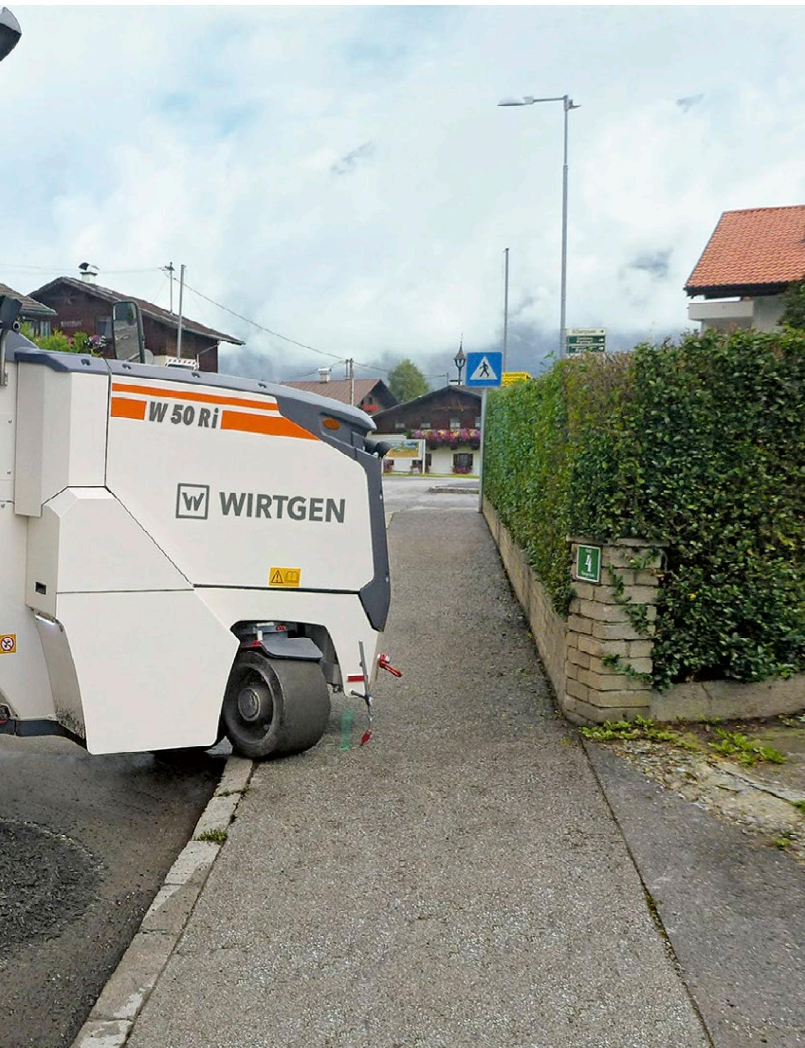
Die leistungsstärkste Halbmeter-Kaltfräse überzeugt mit einem effizienten Bedienkonzept bei einer Arbeitsbreite von 0,5 oder 0,6 m. Einfach bedienbare Zusatz- und Automatikfunktionen erhöhen das Leistungspotenzial für eine schnelle Baustellenabwicklung. Eine Vielzahl unterschiedlicher Fräswalzen ermöglicht höhere Flexibilität und Maschinenauslastung.
