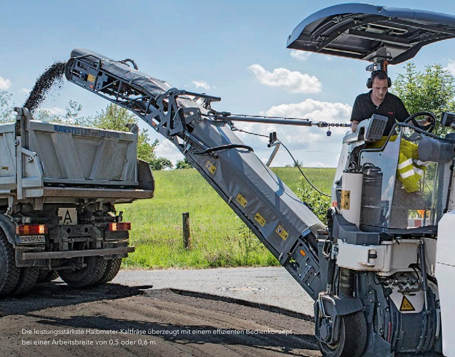
Die leistungsstärkste Halbmeter-Kaltfräse überzeugt mit einem effizienten Bedienkonzept bei einer Arbeitsbreite von 0,5 oder 0,6 m.
