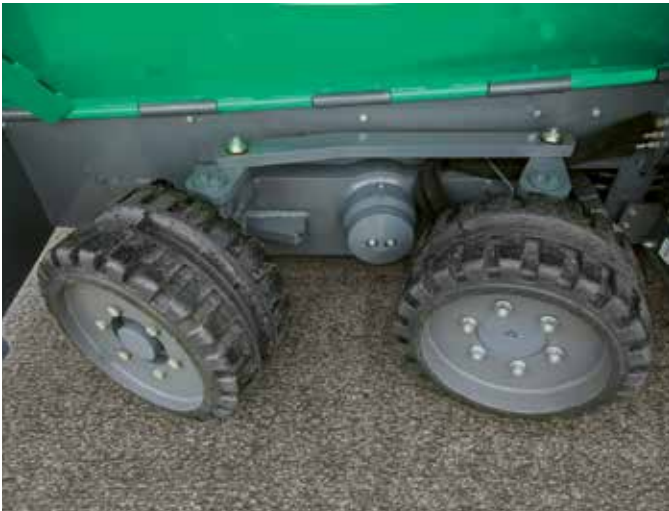
Rodas dianteiras montadas sobre roletes oscilantes. Proporcionam um contato contínuo das rodas com o solo, mesmo em bases irregulares.
