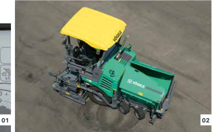
01 有限的功能元件,不需要显示屏。 02 中心转向功能,使外侧转弯半径减小到仅 3.8 m。
