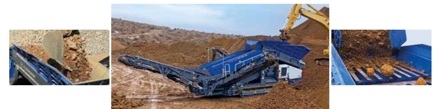
**Der Aufgabetrichter der MOBISCREEN MSS 802(i) EVO ist großzügig dimensioniert und für einen optimalen Materialfluss ausgelegt.**
