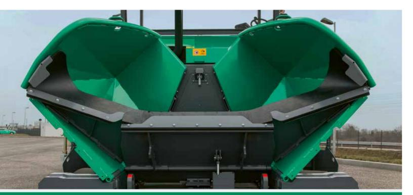
Grande tramoggia di carico del materiale con una capacità di 13 tonnellate
