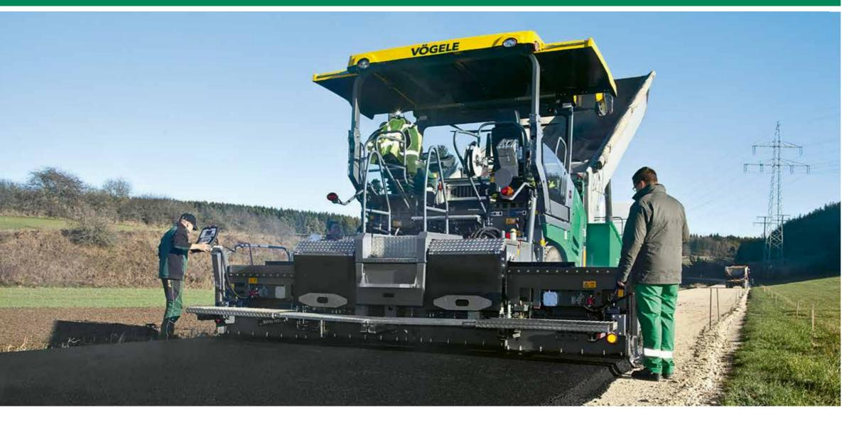
Il tipo AB 500 è il banco universale per tutte le finitrici VÖGELE con una larghezza base di 2,55 metri e sistema di comando ErgoPlus 3 . Grazie alle sue guide telescopiche monotubo regolabili in continuo è in grado di coprire un'ampia gamma d'impieghi, che spazia da 2,55 a 5 m e può essere estesa fino a 8 m montando elementi di allargamento rigidi. L'AB 500 è disponibile con tamper e vibrazione o anche con tamper e una barra di compattazione.
