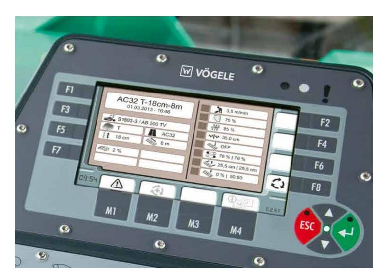
La funzione automatica per i programmi di stesa consente all'operatore di creare programmi di stesa definiti. In questo modo è possibile salvare tutti i principali parametri riguardanti la stesa di un determinato strato, ad esempio uno strato di base in conglomerato bituminoso dello spessore di 18 cm.
