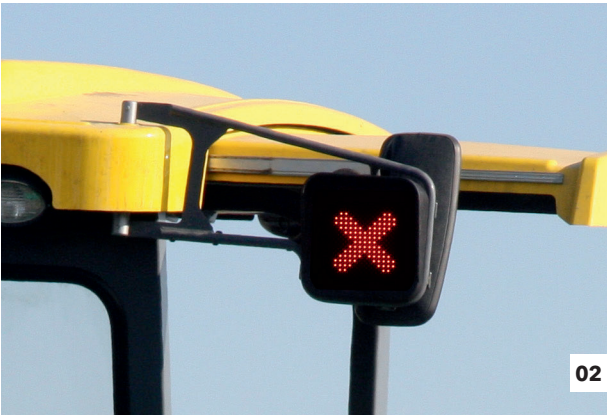
01 Dieselmotor mit drei Drehzahlstufen 02 PaveDock Assistant (Option)
