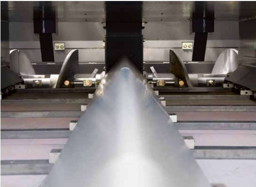
Скребковый конвейер реверсируется одним нажатием кнопки. Подача смеси в обратном направлении выключается автоматически. Функция холостого хода скребкового конвейера включается так же быстро.
