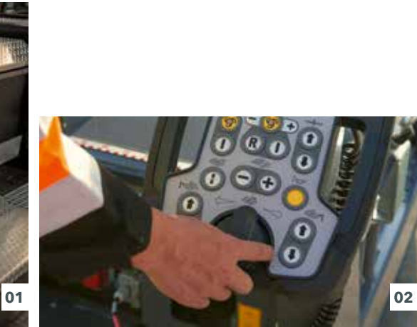
01 Контрастный цветной дисплей выдает четкую картинку даже при плохом освещении. Освещение мощными светодиодными лампами, направленными вниз, дает оптимальный обзор. 02 Рабочая ширина рабочего органа регулируется удобным регулятором SmartWheel.
