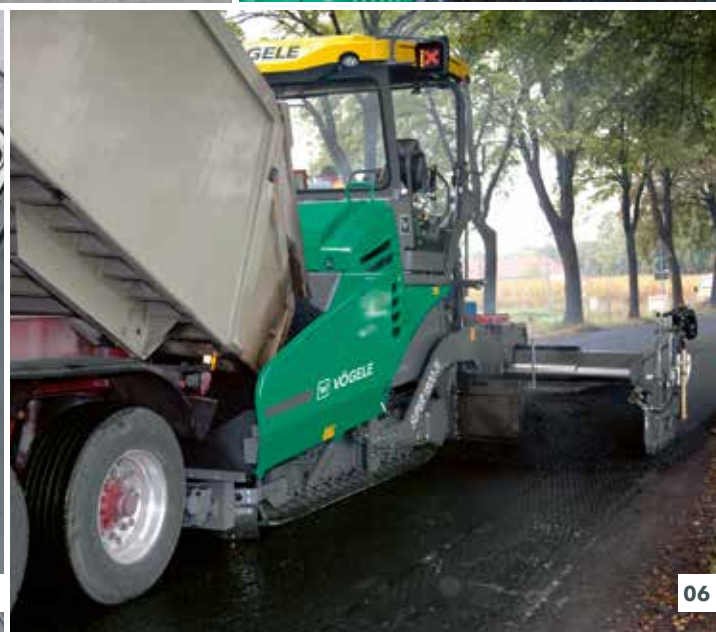
04 Отличный обзор благодаря практичному расположению оборудования на платформе. 05 Автоматизация процессов с помощью пакета функций AutoSet Plus. 06 Оптимальная организация процесса загрузки благодаря подрессорным упорным роликам PaveDock и системе коммуникации PaveDock Assistant.
