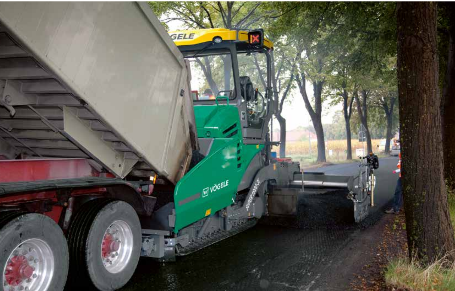
Поддрессоренные упорные ролики PaveDock надежно амортизируют все удары самосвалов.
