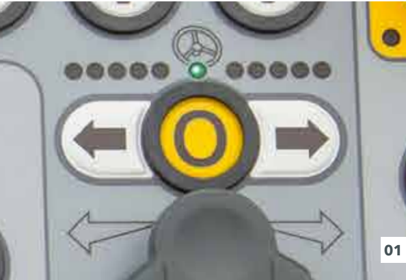
01 Para curvas longas com um raio constante, o ângulo de direção desejado pode ser pré-selecionado usando as teclas de setas.
