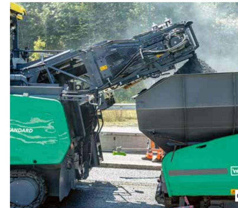
**01** In alternativa al sistema di controllo della distanza laser, per l'MT 3000-3(i) Standard è disponibile anche un controllo della distanza meccanico.
