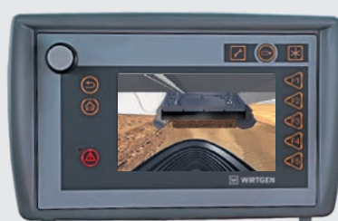
Telecamera di monitoraggio della paratia del tamburo (di fresatura) anteriore
