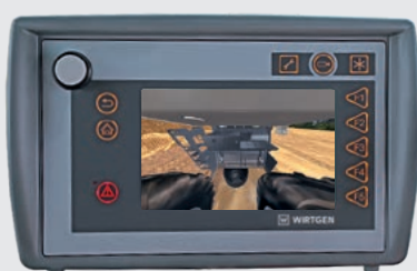
Telecamera di monitoraggio della paratia del tamburo (di fresatura) posteriore
