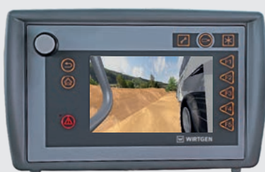
Telecamera di monitoraggio del lato sinistro della macchina
