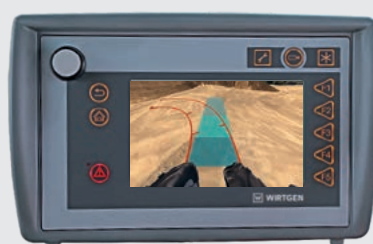
Telecamera di monitoraggio della zona posteriore
