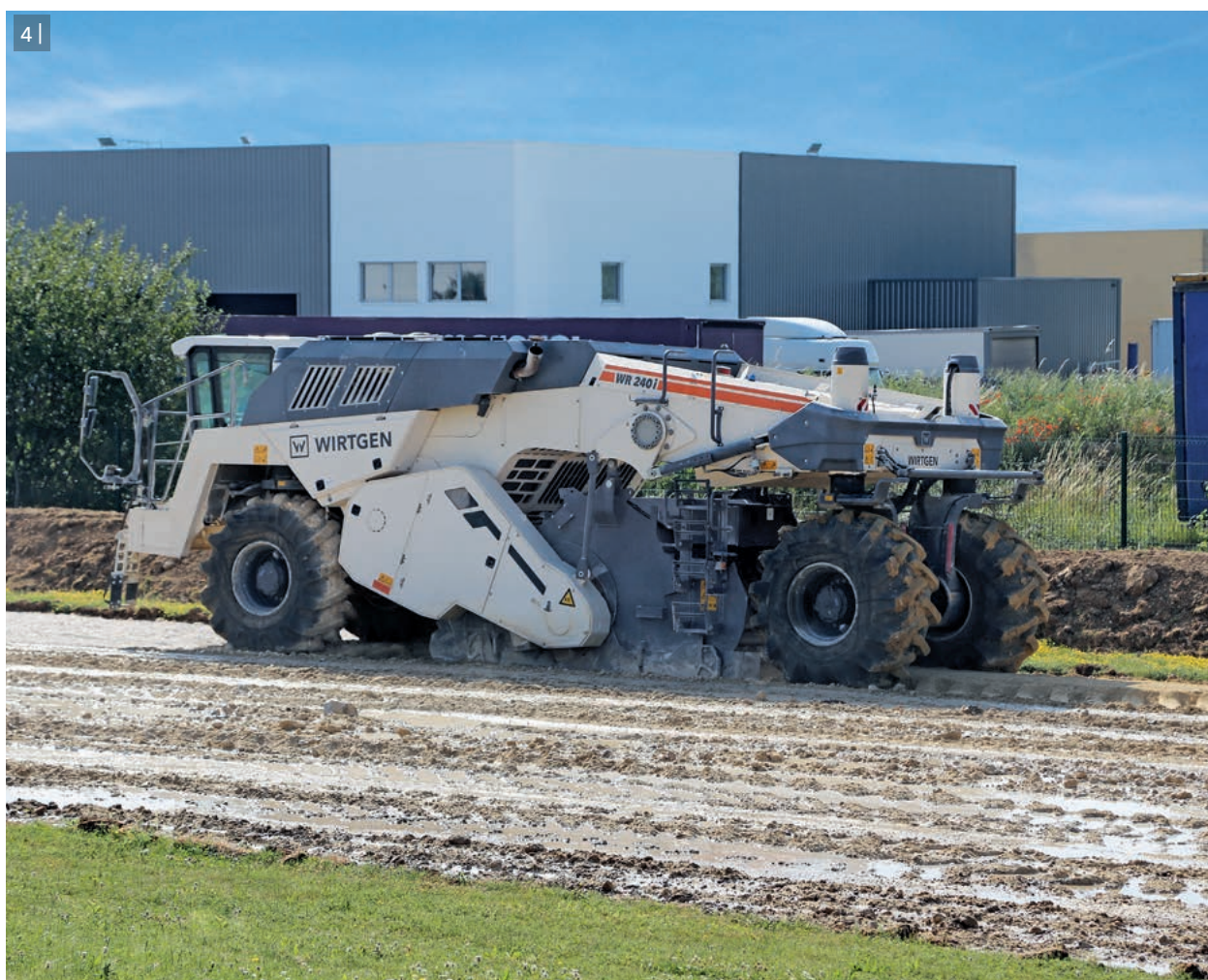
1 - 4 | Bei der Bodenstabilisierung wird ungenügend tragfähiger Untergrund in gut einbaufähigen und verdichtbaren Boden verwandelt.
