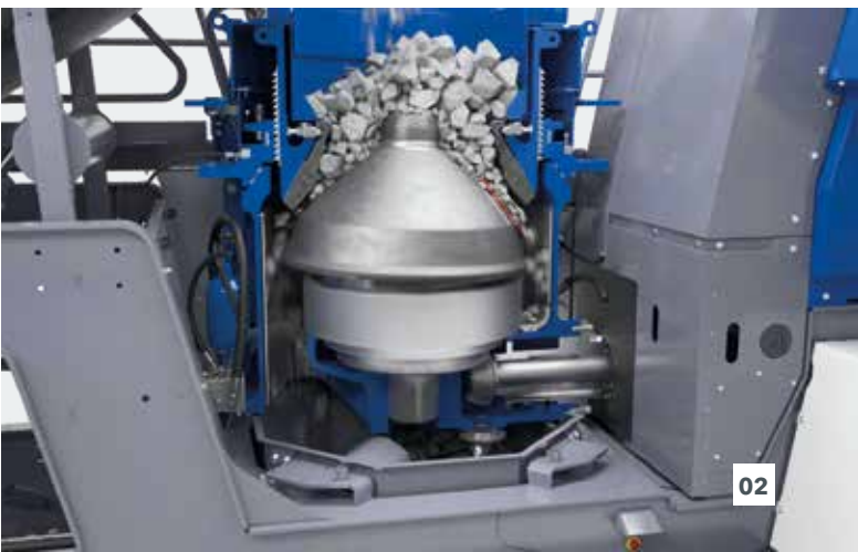
01 Passaggio del frantoio 02 Regolazione della fessura di frantumazione
