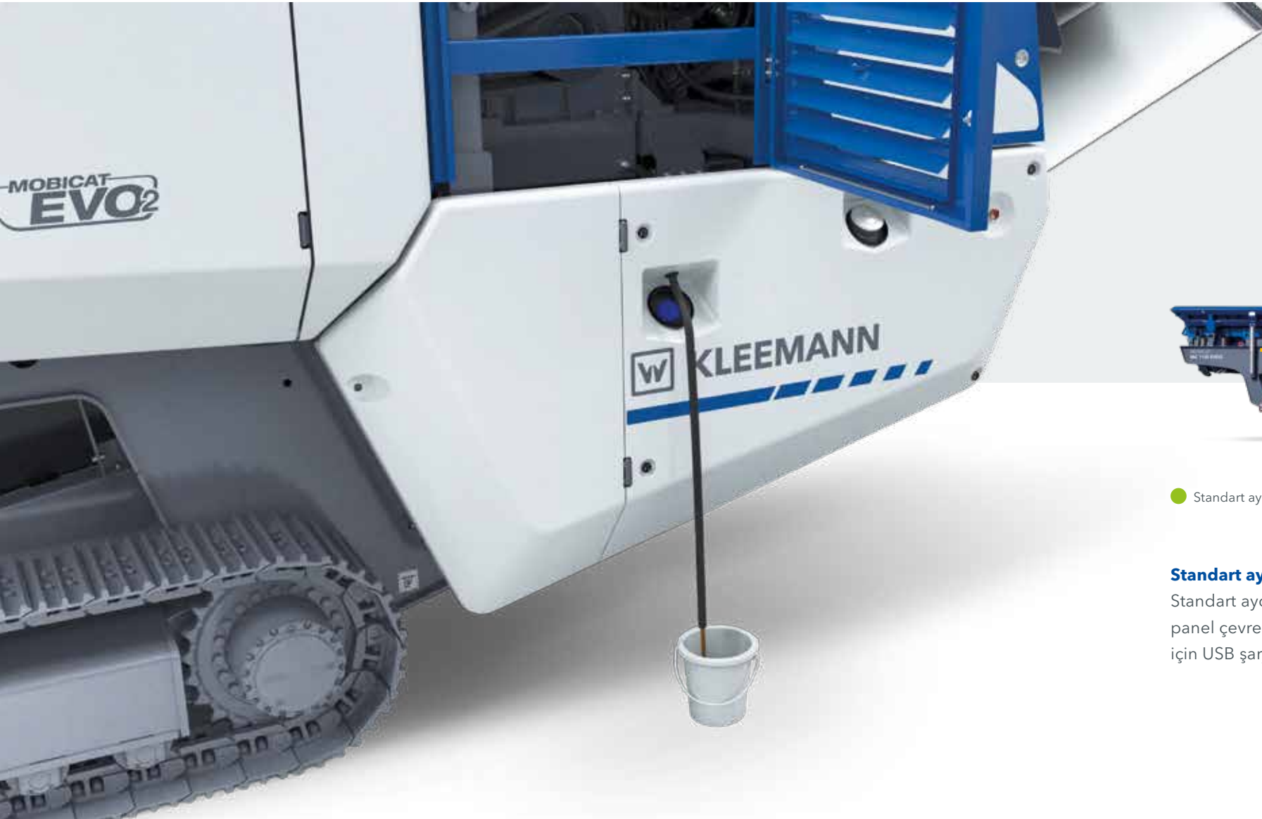
Merkezi drenaj noktası
