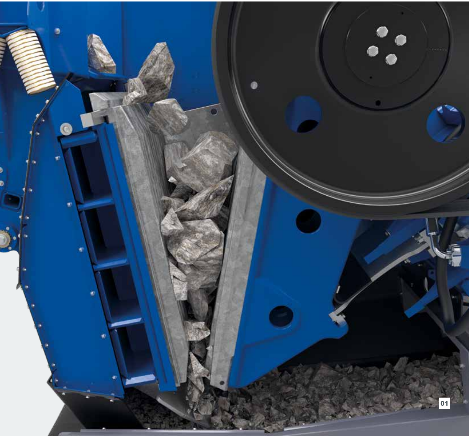
01 Kırıcı geometrisi 02 Deflektör plakası 03 Kırıcı deblokaj sistem
