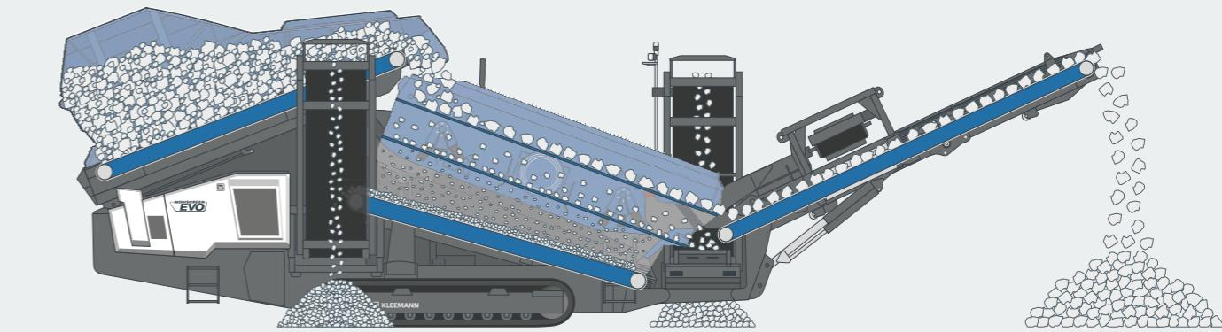
Mit ihrem proportional gesteuerten Fahrwerk lässt sich die Grobstücksiebanlage schnell und präzise versetzen, sei es vom Tieflader zum Einsatzort oder innerhalb der Baustelle. Das Klappen der Seitenaustragungsbänder erfolgt ohne Montage bzw. Demontage von Bauteilen und sorgt so für eine Reduzierung der Rüstzeiten. Mehr Einsatzvariabilität bietet eine in drei Höhen klappbare
