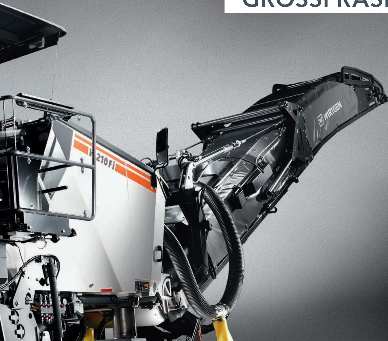
Großfräsen haben eine mittig unter der Maschine angeordnete Fräswalze sowie ein zweiteiliges Frontverladesystem. Über das schwenk- und höhenverstellbare Abwurfband lassen sich Lkw schnell und flexibel beladen.
