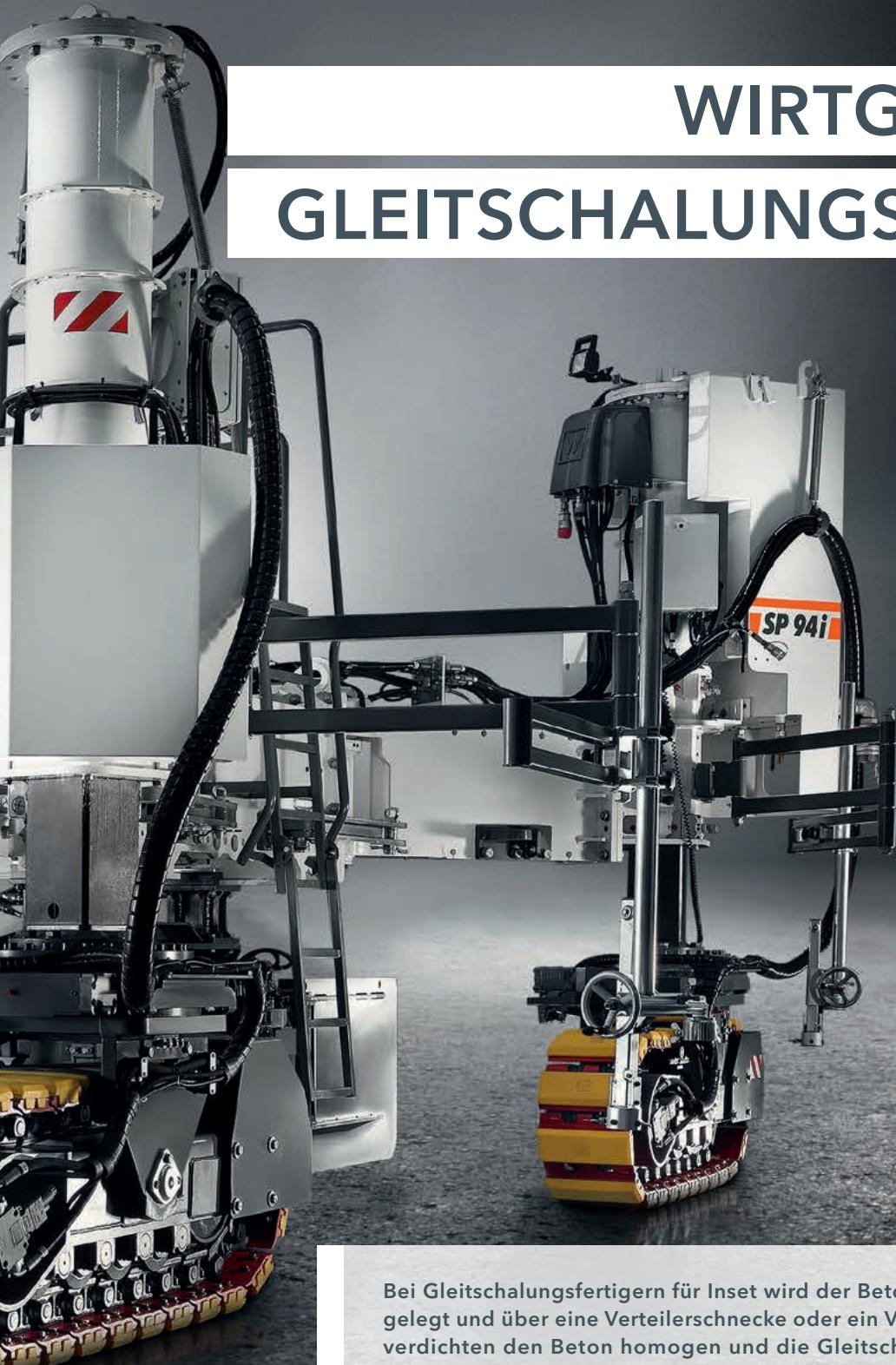
Bei Gleitschalungsfertigern für Inset wird der Beton direkt vor der Maschine abgelegt und über eine Verteilerschnecke oder ein Verteilerschwert verteilt. Rüttler verdichten den Beton homogen und die Gleitschalung formt ihn während der Vorwärtsfahrt in definierter Breite sowie Dicke. Integrierte Dübel- und Ankersetzer positionieren Dübel und Anker gemäß den Vorgaben.
