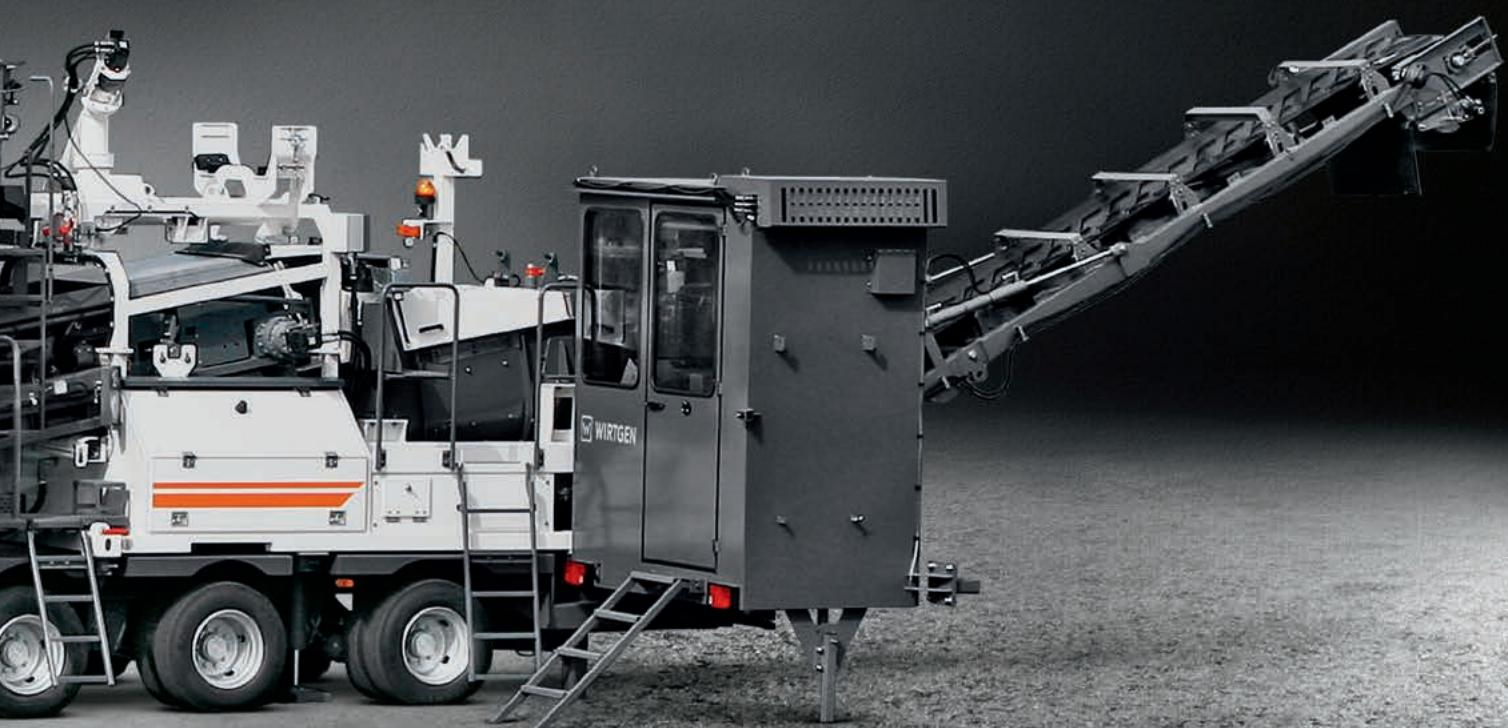
Die mobile Kaltrecycling-Mischanlage kann einfach transportiert und schnell in direkter Nähe zum Einsatzort aufgebaut werden. Der robuste Zweiwellen-Zwangsmischer erzielt hohe Mischleistungen. Rezepturgenaues Mischen wird durch mikroprozessorgesteuerte Einsprühanlagen für die Zugabe von unterschiedlichsten Bindemitteln erreicht.
