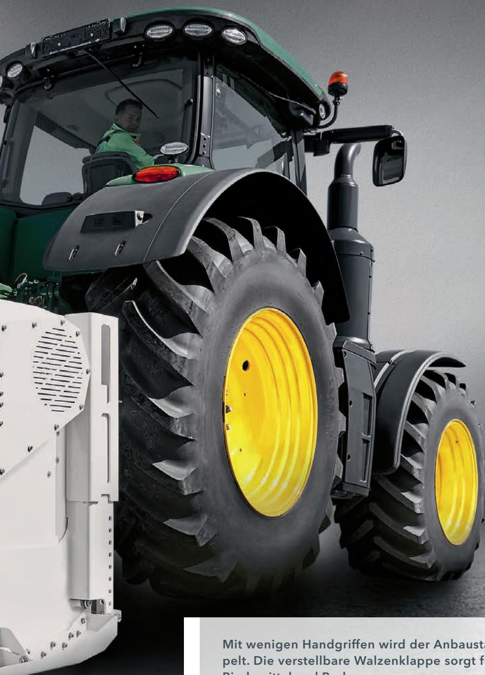
Mit wenigen Handgriffen wird der Anbaustabilisierer an einen Traktor angekoppelt. Die verstellbare Walzenklappe sorgt für eine homogene Mischqualität von Bindemittel und Boden.
