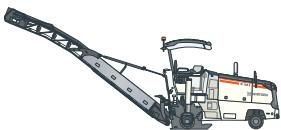
**W 100 R****Fräsbreite:** 1.000 mm**Frästiefe:** 0 - 300 mm**Motorleistung:** 155 kW / 208 HP / 211 PS**Betriebsgewicht, CE\*:** 14.700 kg
