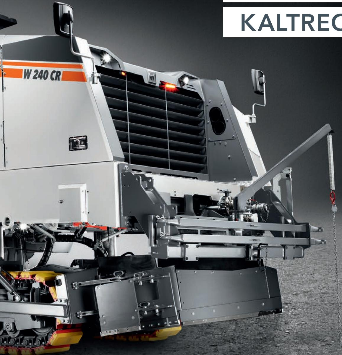
Kaltrecycler der CR-Baureihe werden für wirtschaftliches Recyceln von Fahrbahnen eingesetzt. Die exakte Zugabe von Bindemitteln und Wasser erfolgt über mikroprozessorgesteuerte Einsprühanlagen.
