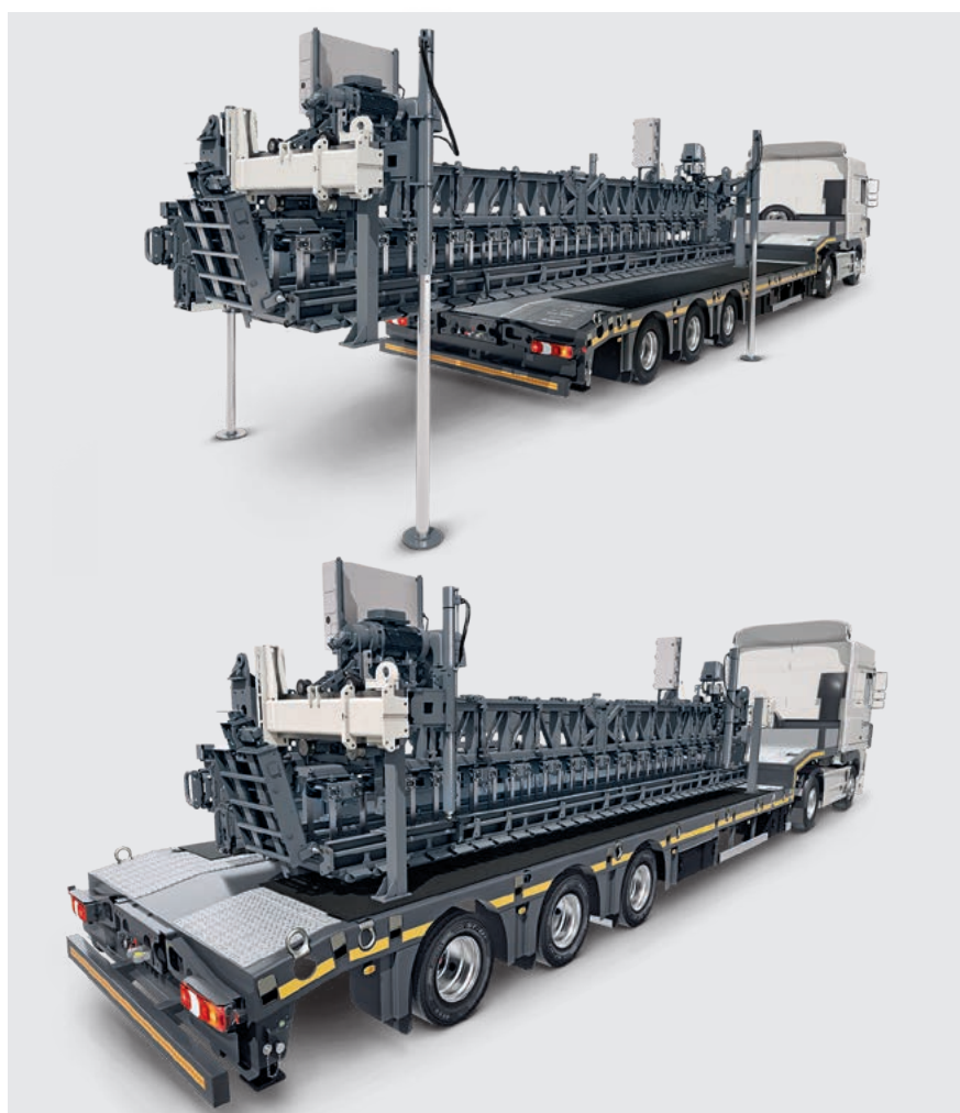
Самозагружающаяся система вибропогружения дюбелей (СВД).
