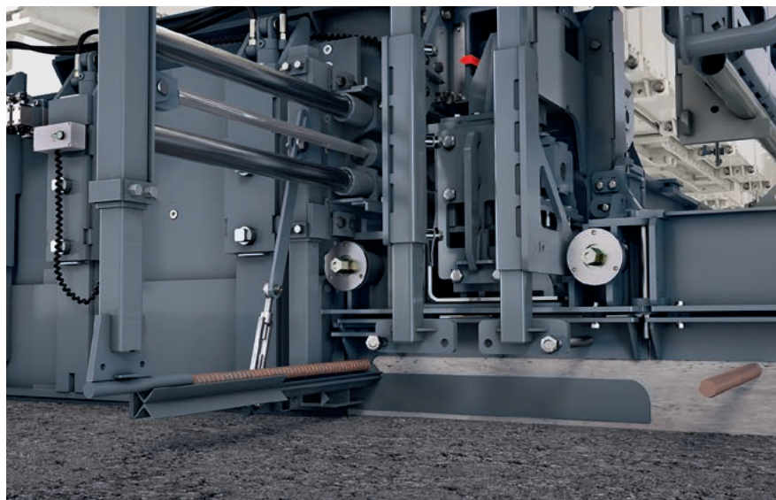
Отдельное устройство для погружения боковых анкеров.
