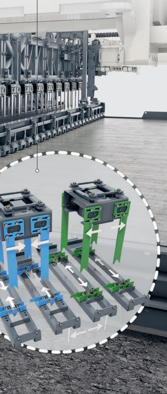
Самозагружающаяся система вибропогружения дюбелей (СВД).
