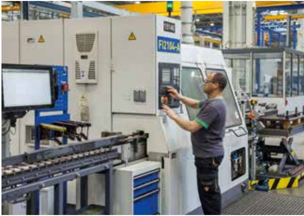
El temple por inducci n de t mperes y listones de presi n garantiza una larga vida  til.
