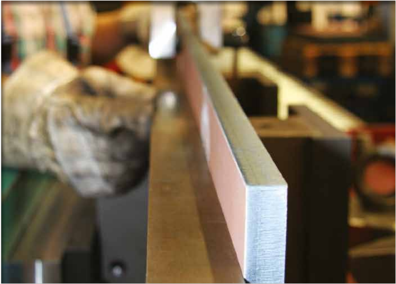
El enderezado sin tensiones, con una desviaci n de la planicidad de 2/10 mm como m x. proporciona una larga vida  til de la chapa alisadora gracias a su desgaste uniforme.
