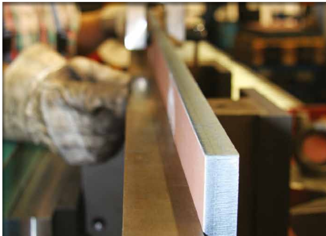
Das spannungsfreie Richten mit einer Ebenheitsabweichung von max. 2/10 mm sorgt für eine hohe Lebensdauer des Glättblechs durch gleichmäßigen Verschleiß.
