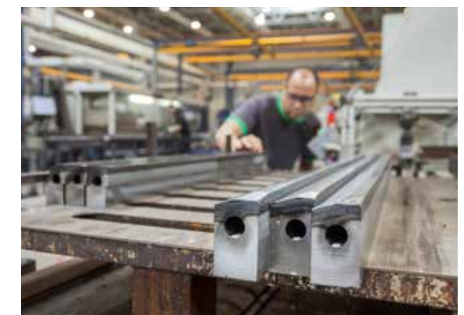
Gleichmäßige Einhärtetiefe bei Tamper und Pressleiste von 5 mm.
