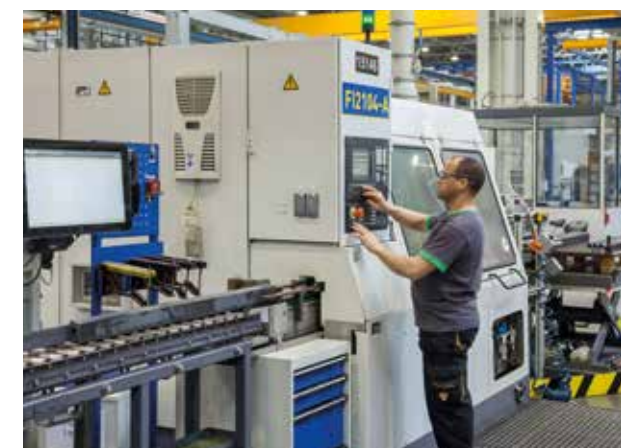
Induktionshärtung von Tampern und Pressleisten garantiert Langlebigkeit.
