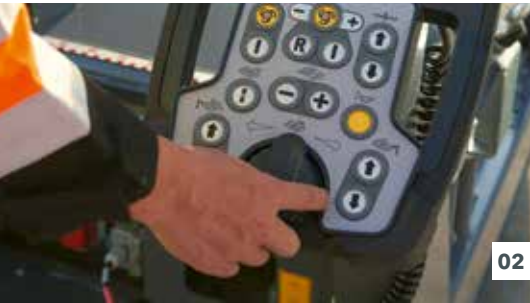
01 高对比度的彩色显示屏，确保了即使在照明不好的工况下，也能理想的读取信息。另外，向下倾斜的大功率 LED 照明灯使机手对边板相关区域拥有良好视野。 02 通过方便地调节熨平板宽度控制开关，从而精确、有效地控制熨平板宽度。
