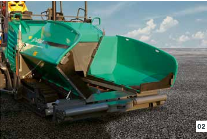
01 摊铺机通过旋转控制器进行转向, 这使得机手即使在狭窄空间, 也能够精准地操控机器。 02 料斗两侧的料斗壁能够单独折叠。
