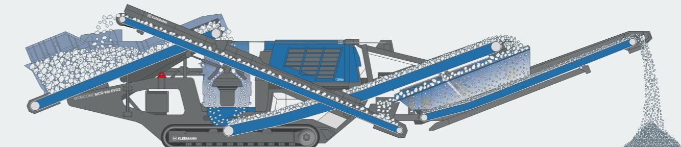
Der mobile Kegelbrecher ist wendig und gut transportierbar – dank kompakter Transportmaße und kurzen Rüstzeiten ist die Maschine vielseitig einsetzbar und schnell betriebsbereit. Ausgestattet mit intelligenten und effektiven Überlastsystemen wie „Tramp Release“ oder „Ring Bounce Detection“ können auch unter erschwerten Bedingungen Sicherheit und stabile Prozesse gewährleistet werden – für beste Produktqualität.
