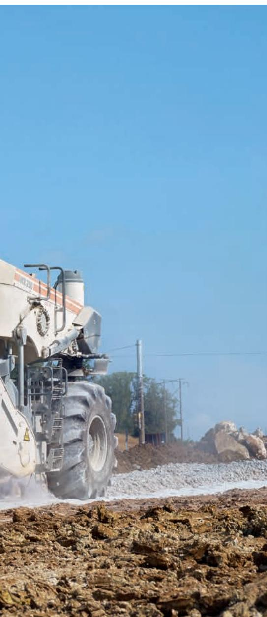
7 | Дополнительно встроенный распределитель вяжущего «S-Pack» (Spreader-Pack) предназначен для подачи вяжущего без образования пыли.
