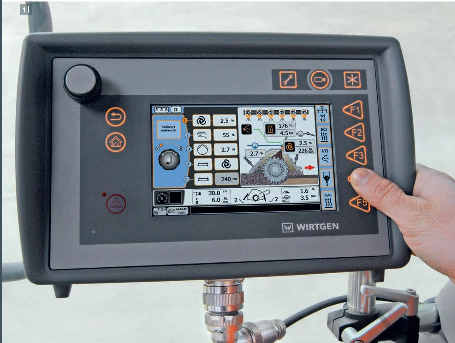
2 | Панели управления можно настроить в соответствии с различными проектными требованиями.
