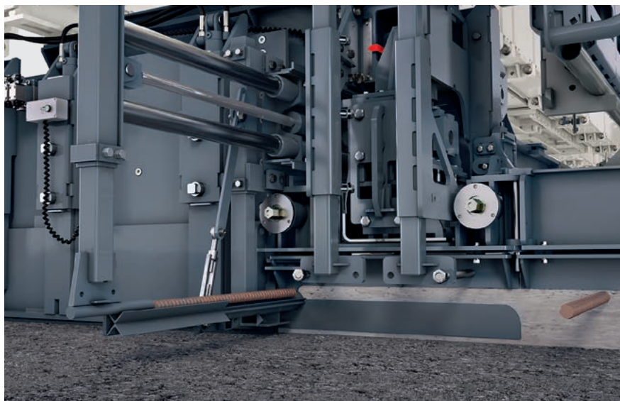
Insertador de barras de anclaje longitudinales laterales por separado.
