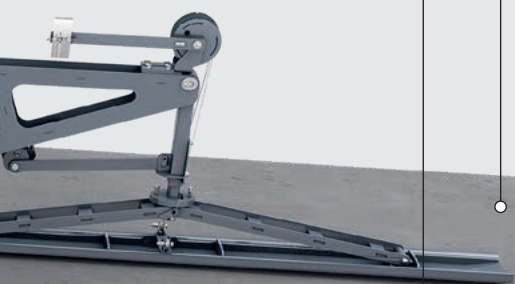
Insertador de barras de anclaje longitudinales laterales por separado.
