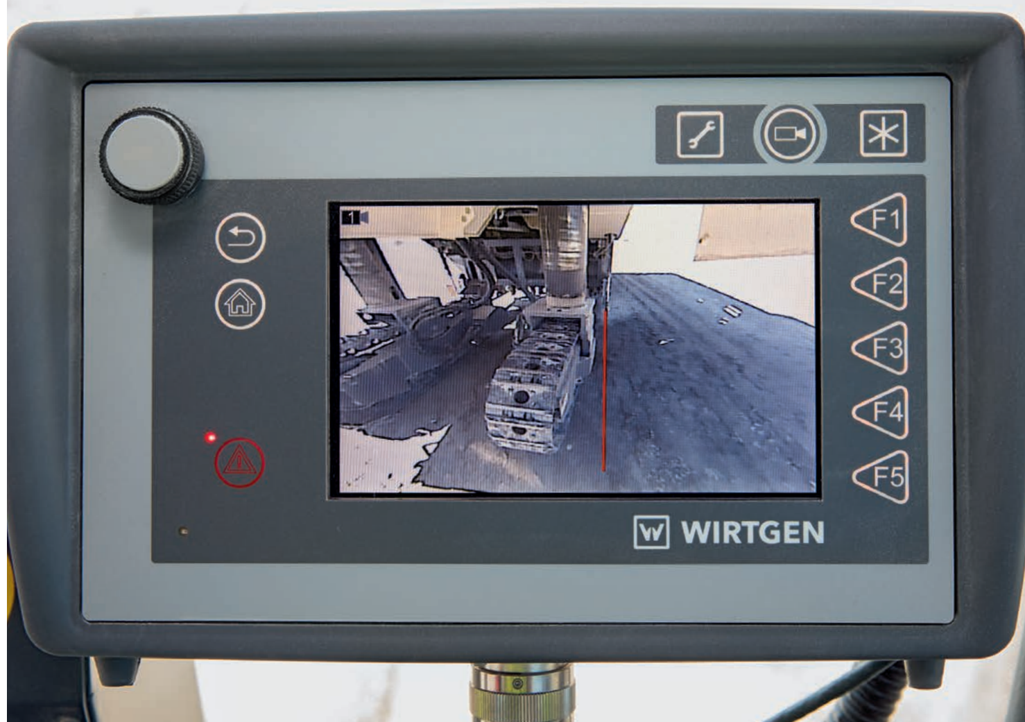
2 | Быстрое маневрирование с использованием камеры заднего вида увеличивает производительность машины.
