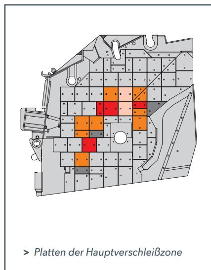
Um das hochwertige Brechergehäuse vor Beschädigungen zu schützen, ist es komplett mit besonders verschleißfesten Platten verkleidet. Die Verschleißbeanspruchung variiert dabei innerhalb des Gehäuses zum Teil erheblich. Um die Wechselzeiten und Verschleißkosten zu reduzieren, bietet KLEEMANN spezielle auftragsgeschweißte Platten an.
