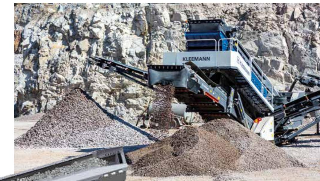
**i** Die MSC EVO Siebanlagen verfügen über einen Hydraulik-Port zum Betreiben eines hydraulisch angetriebenen Haldenbandes.
