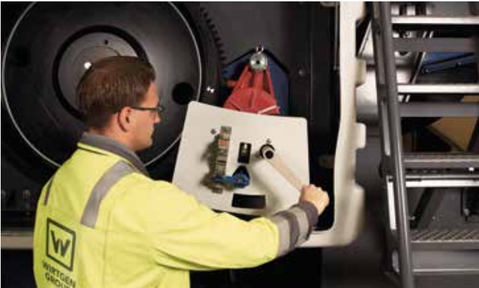
> 借助手柄，机手可安全地转动转子，并将其移动至理想位置，以便更换板锤。
