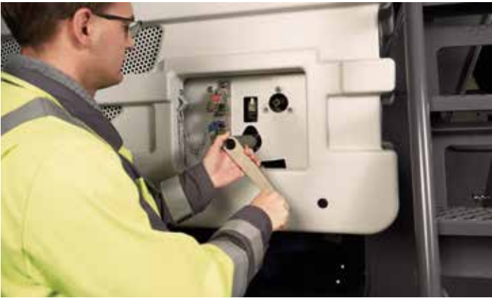
> 转子转动及锁定装置被启用并借助手柄转动。
