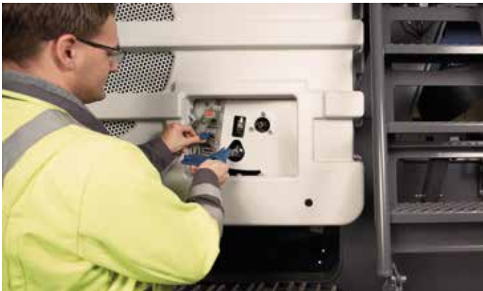
> 将控制元件插入启动装置；转子被安全锁定，锁键被释放。
