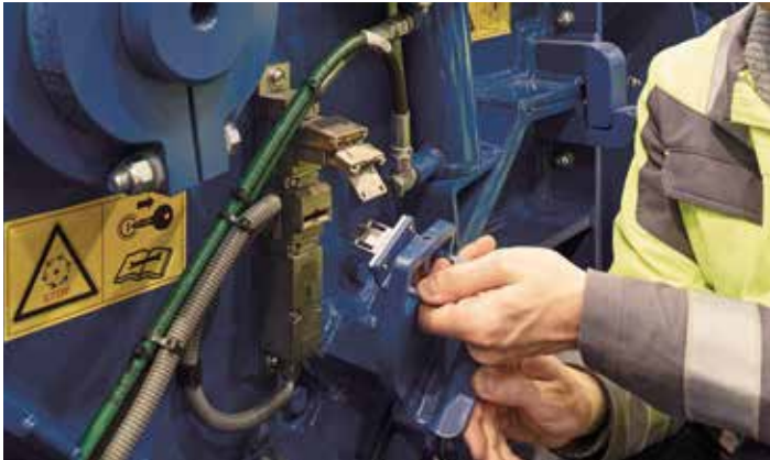
> 插入专用锁键后，破碎机罩壳被打开。打开罩壳时，专用锁键不能被拔出，堵塞的材料可被安全地清除。
