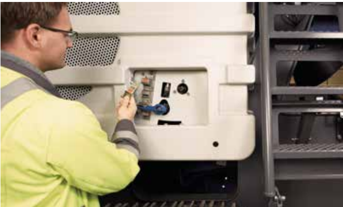
> 锁键移除后，转子会保持安全锁定状态。
